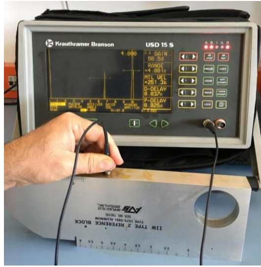
Görsel 3.27. Kalibre bloğu üzerinde test işleminde kullanılan bir ultrasonik muayene cihazı
