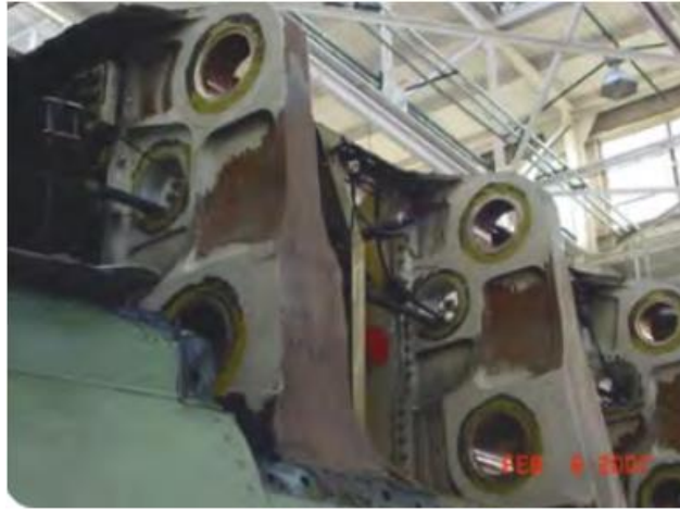
Görsel 3.12. F-18 uçağında korozyon (Rose and Legg, 2014)
