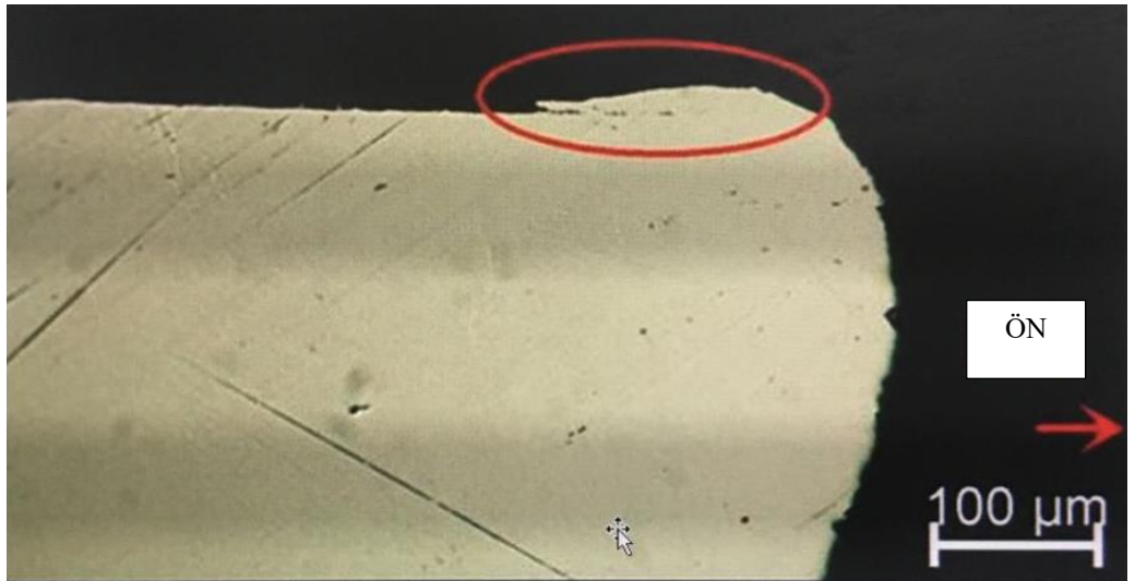
Görsel 4.40. Dovetail yuvasında meydana gelen çapaklanma
