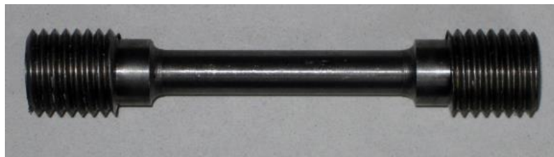
Görsel 3.21. Sürünme deneyi öncesinde test numunesi (Chvostova and Dzigan, 2017)
