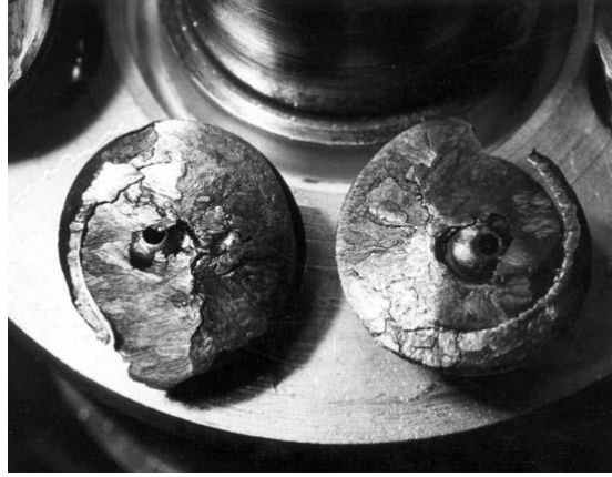
Görsel 3.20. Bir uçağın yakıt pompasında meydana gelen aşınma (Ramachandran vd., 2005)
