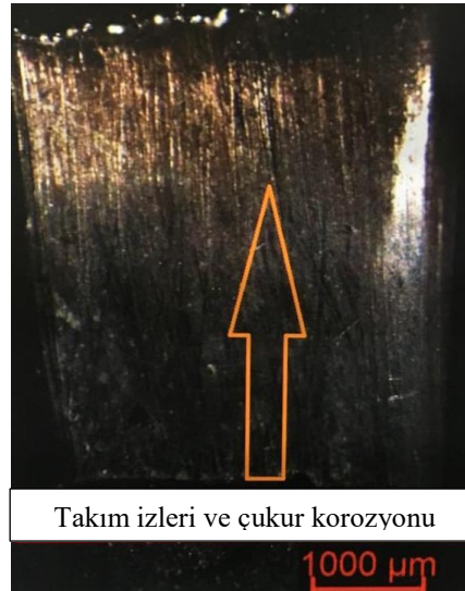
Görsel 4.45. Takım izleri ve çukur korozyonu
