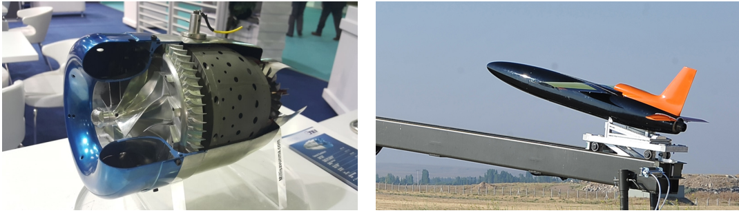
Şekil 2.2. TJ90 turbojet motoru ve Şimşek Hedef Uçak Sistemi [30]
