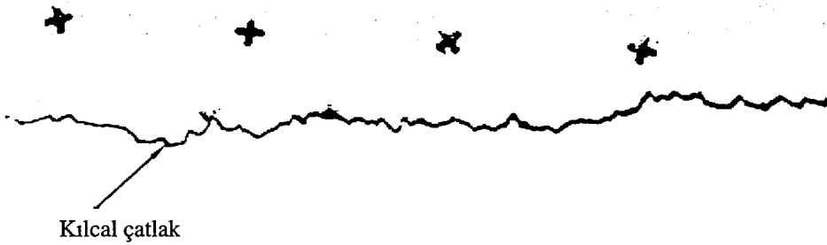
Şekil 6.9. Boeing 737-800 tipi uçağının kanatçığı üzerinde oluşan hasarın sıvı penetrant yöntemiyle tespiti [17]
