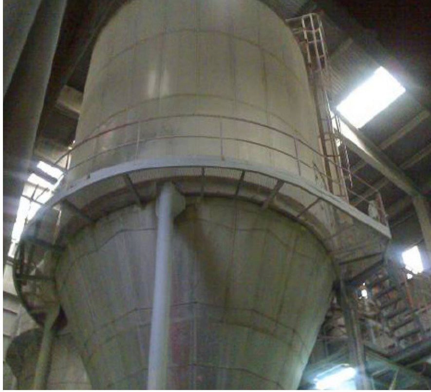
Şekil 4.7. Çalışmada kullanılan endüstriyel püskürtmeli kurutucu
