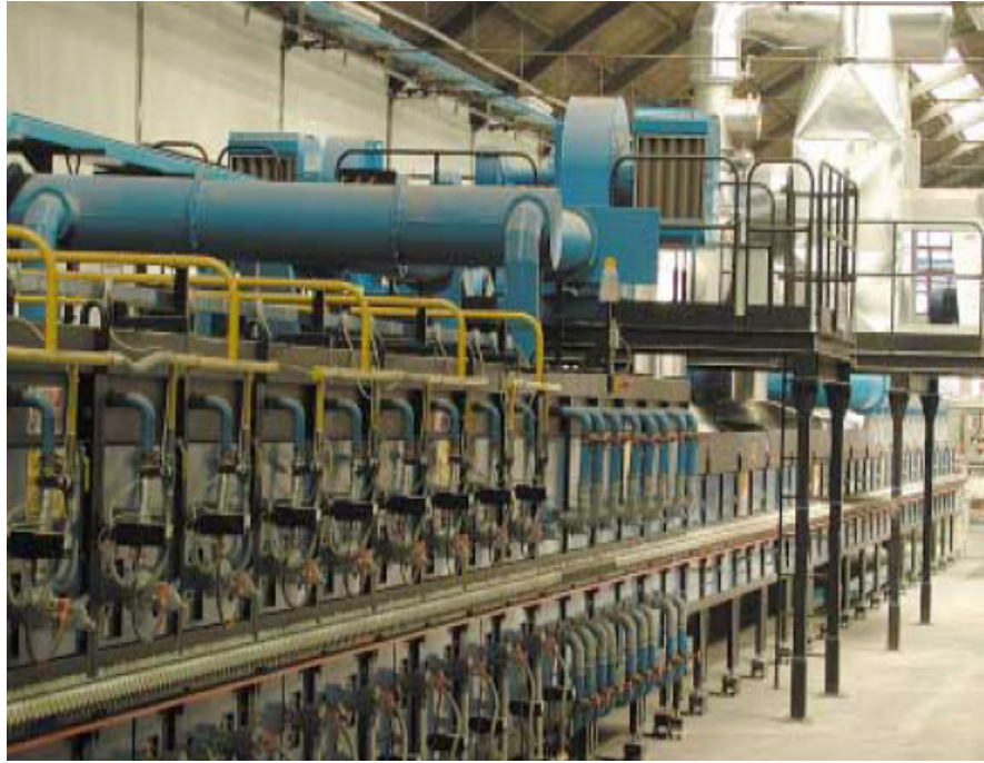
Şekil 4.9. Çalışmada kullanılan endüstriyel rulolu fırın
