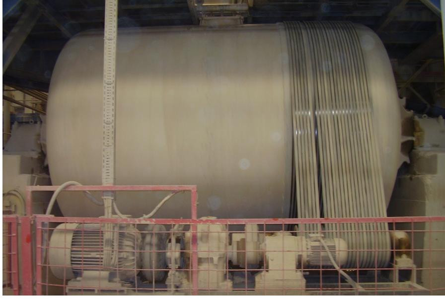
Şekil 4.1. Çamur hazırlama sürecinde kullanılan süreksiz bilyeli değirmen
