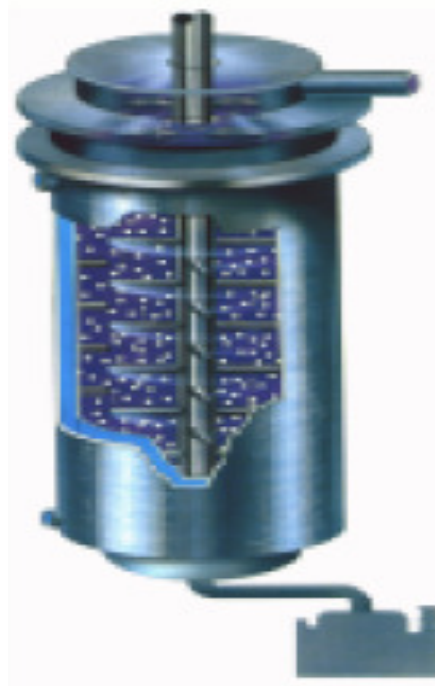
Şekil 3.21. Sürekli atritörlerinin şematik gösterimi [109]
