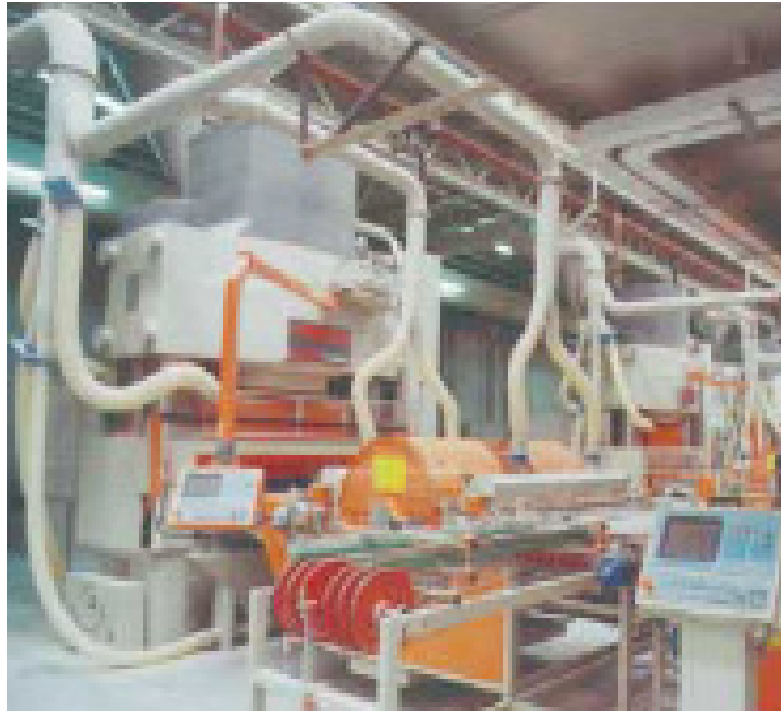
Şekil 4.8. Çalışmada kullanılan endüstriyel hidrolik pres
