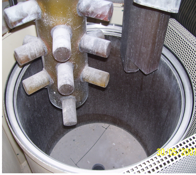
Şekil 4.3. Çalışmada kullanılan atritör değirmenin karıştırıcı kol ve iç haznesinin görüntüsü
