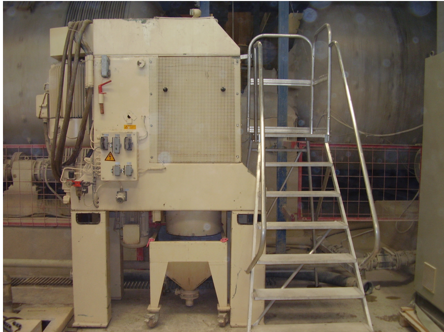
Şekil 4.2. Çamur hazırlama sürecinde kullanılan atritör değirmen
