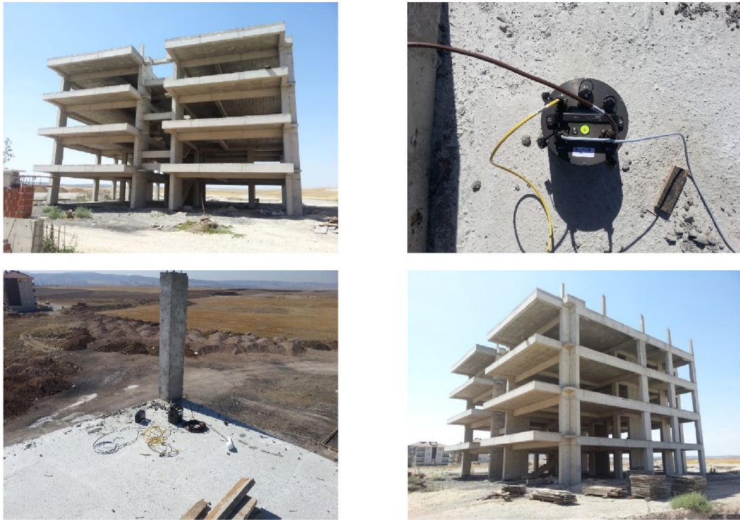
Görsel 4.8. BN01 kodlu bina karkas aşamasında iken CMG-5TCDE ivmeölçerler ile çevresel titreşim ölçümü
