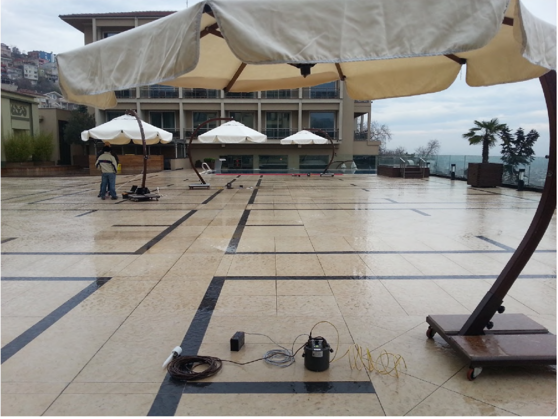
Görsel 4.7. Fayans kaplama üzerine yerleştirilen CMG-5TCDE ivmeölçer
