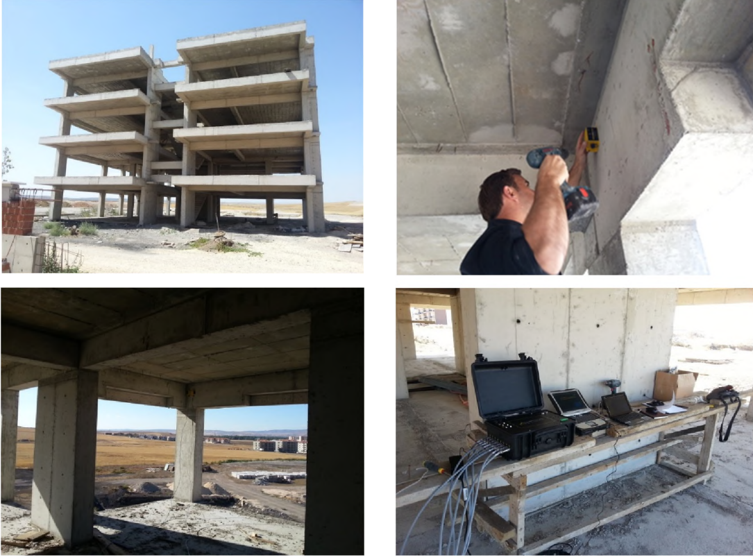
Görsel 4.9. BN01 kodlu bina karkas aşamasında iken TDG-7021 ivmeölçerler ile çevresel titreşim ölçümü
