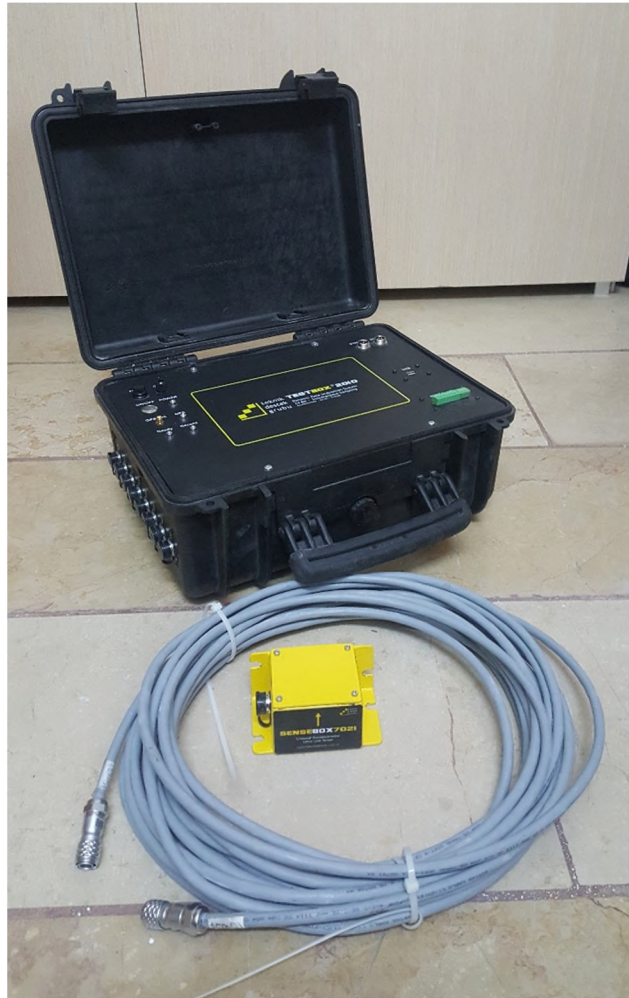
Görsel 4.4. TDG Sensebox 7021 ivmeölçer ve TDG Testbox 2010 veri toplama ünitesi
