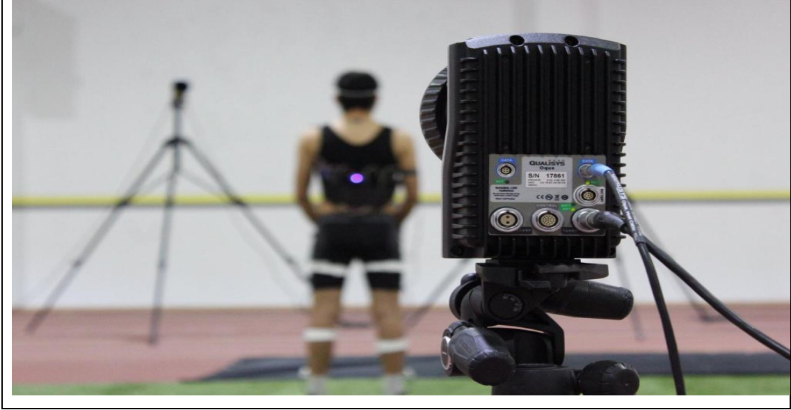
Görsel 3.12. Sistemlerin senkronizasyonunda kullanılan led ışık
