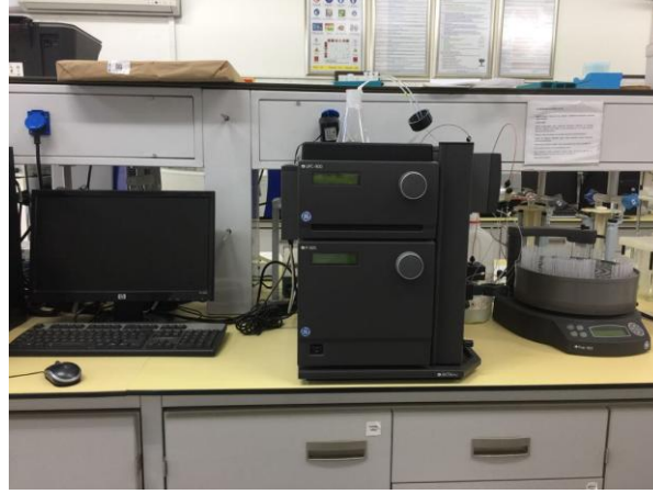
Şekil 2. 2. Bu çalışmada kullanılan FPLC sistemi
