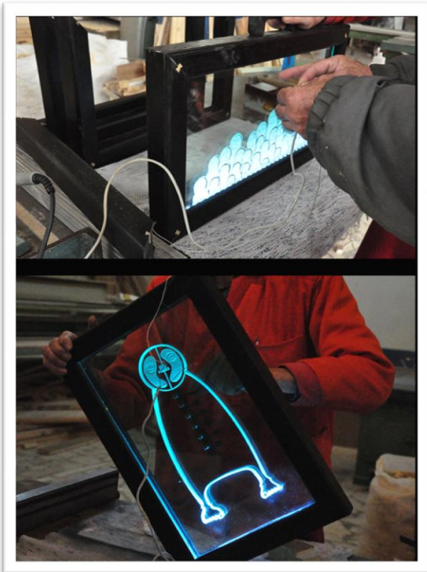
Görsel 89 – Montajı yapılmış çerçevelerin aydınlatma kontrolü
