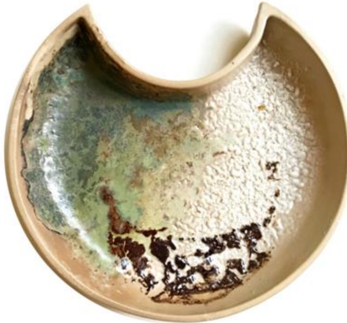
Görsel 5.13. Uygulama 5, %60 Havuç Külü - %40 Üleksit + %1 \text{Cr}_2\text{O}_3 , Zencefil Külü %60 - Potasyum Feldspat %40 + %1 \text{Cr}_2\text{O}_3 , %60 Yer Elması Külü - %40 Potasyum Feldspat + %1 \text{Cr}_2\text{O}_3 , 18 x 18 x 3cm, 1200°C, 2020
