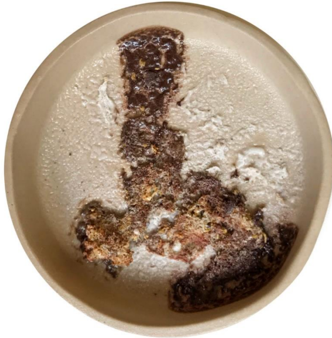
Görsel 5.23. Uygulama 14, Şalgam Külü %60 Potasyum Feldspat, %40Yer Elması Külü %60 Potasyum Feldspat %40 + %1 Cr_2O_3 , 9 x 9 x 2cm, 1200°C, 2020 (Ereshova, 2020)
