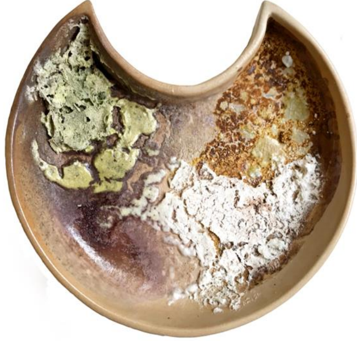
Görsel 5.14. Uygulama 6, %60 Zencefil Külü - %40 Karışım, %60 Soğan Külü - %40 Karışım + %1 \text{Fe}_2\text{O}_3 , Zencefil Külü %60 - Potasyum Feldspat %40 + %1 \text{Cr}_2\text{O}_3 , 18 x 18 x 3cm, 1200°C, 2020 (Ereshova, 2020)
