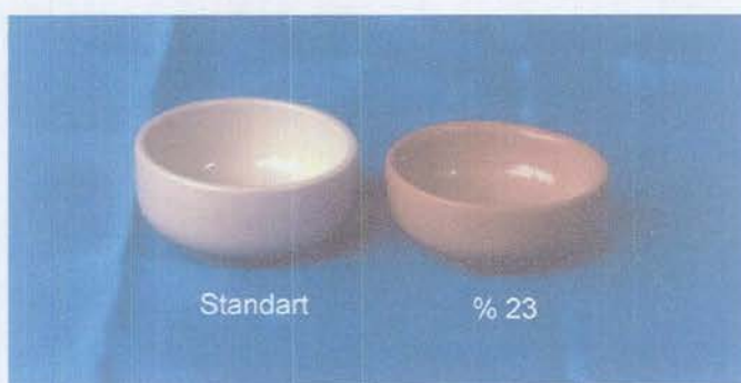
Şekil 6.4. Standart ve % 23 flotasyon atığı katkılı stoneware objelerin şeffaf sır uygulanıp 1150 °C'de pişirimleri sonucu görünüşleri
