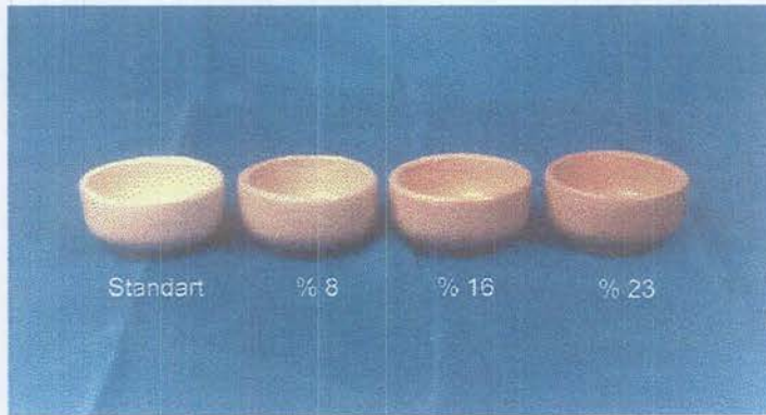
Şekil 6.7. Standart ve % 8-23 flotasyon atığı katkılı porselen objelerin şeffaf sır uygulanıp 1150 °C'de pişirimleri sonucu görünüşleri
