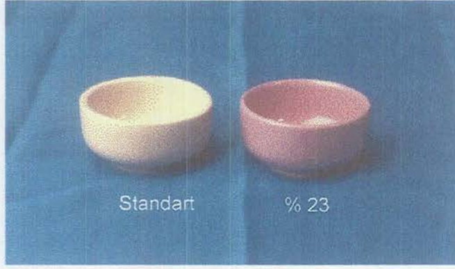
Şekil 6.5. Standart ve % 23 flotasyon atığı katkılı stoneware objelerin şeffaf ve renkli şeffaf sır uygulanıp 1150 °C'de pişirimleri sonucu görünüşleri
