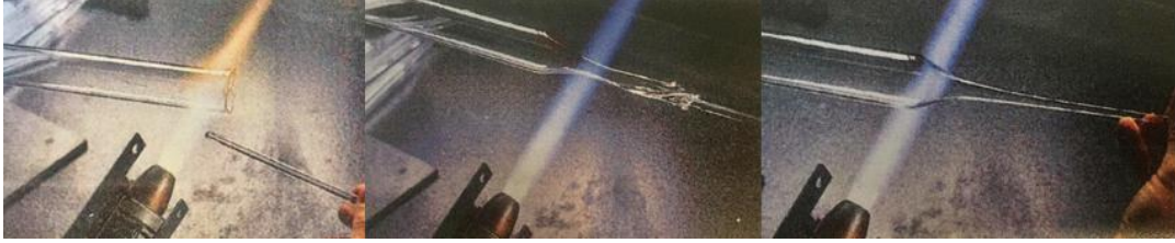
Görsel 5.36. Borosilikat cam sap çekme işlemi (L. Kopp, vd., s. 216, 2011)
