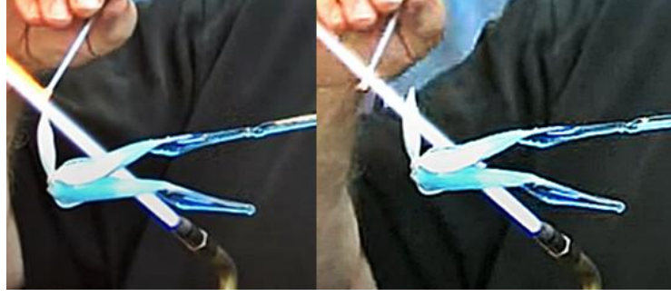
Görsel 5.15. Ayrırma tekniği biblo uygulama aşaması ( https://www.youtube.com/watch?v=FYEQncNI4W0 )
