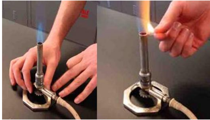
Görsel 3.8. Bunsen Burner şaloma, çalışma aşaması
