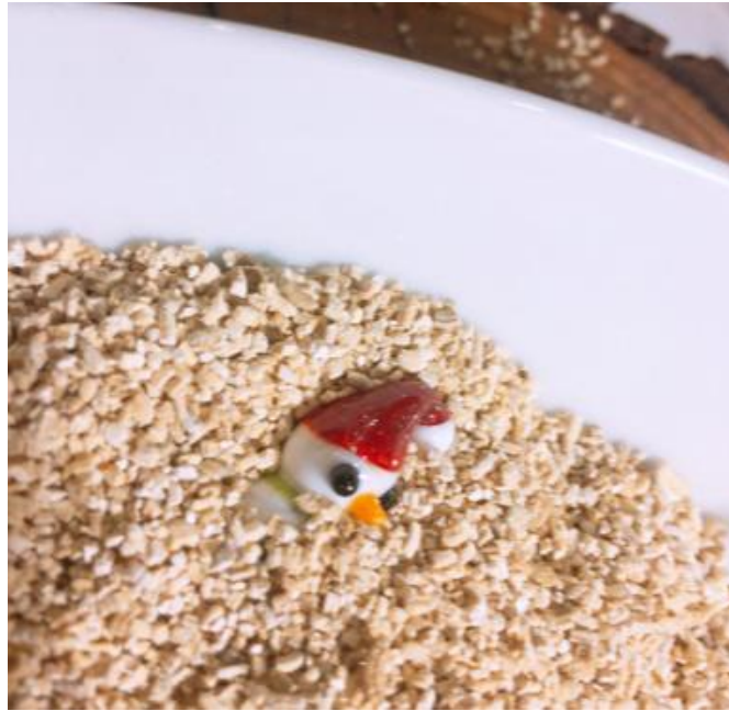
Görsel 4.16. Vermikülit içerisinde soğumaya bırakılmış cam (B. Tosun Akın, 2021)
