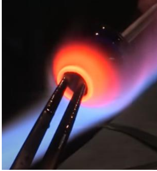
Görsel 5.39. Farklı materyaller kullanılarak ağız açma işlemi
