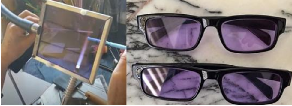
Görsel 4.7. Didymium cam çalışma aşaması
