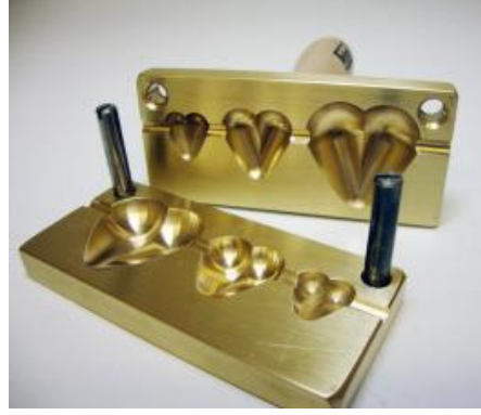
Görsel 5.30. Alevde cam şekillendirme için kullanılan kalıp örnekleri ( https://www.instagram.com/p/Ben6cilnVeo/ )
