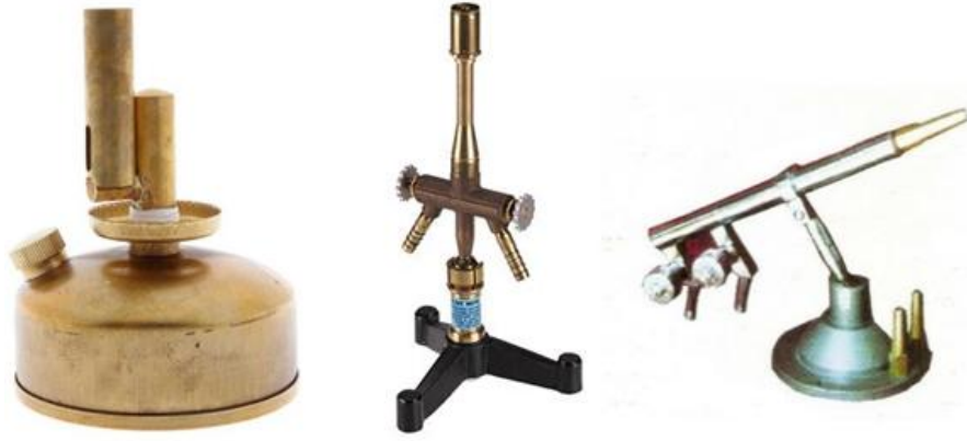
Görsel 3.9. Blast Burner şaloma gelişim süreci
