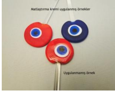
Görsel 5.49. Kumlama kremi uygulanmış cam boncuk ( https://www.cammalzeme.com/cam-matlastirma-sivisi-550gr )
