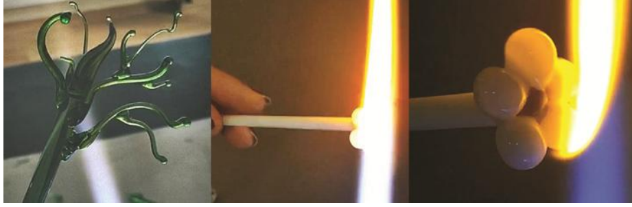
Görsel 5.18. Ekleme işlemi gerçekleştirilmiş cam (B. Tosun Akın, 2021)
