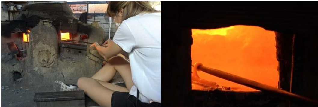
Görsel 6.9. Geleneksel cam boncuk fırınında ergimiş camın asebeye sarılması işlemi (B. Tosun Akın, 2021)
