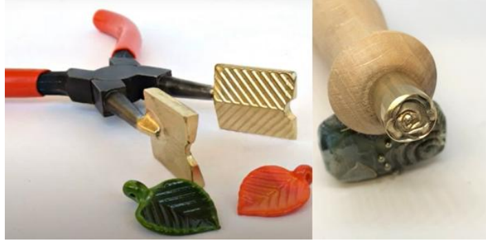
Görsel 5.40. Sıcak cam yüzeyine doku oluşturma yöntemi
