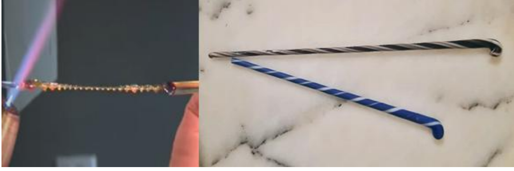
Görsel 5.24. Bölgesel farklı kalınlıklara sahip cam çubuklar
