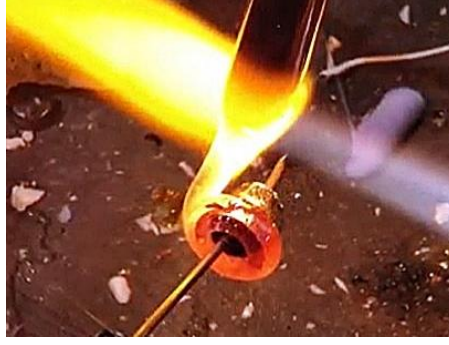
Görsel 5.3. Mandrele cam sarma işlemi
