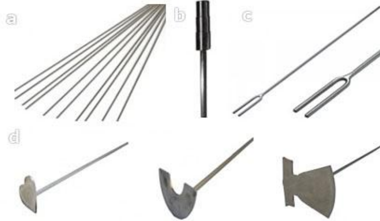
Görsel 4.26. 2,0mm. Mandrel(a), yüzük mandreli(b), düğme mandreli(c), özel tasarım mandreller(d) ( https://www.cammalzeme.com/page.php?page=1&act=arama&str=mandrel )
