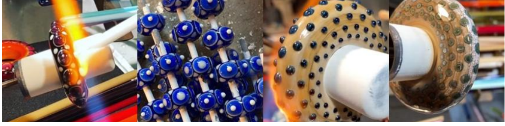
Görsel 5.43. Noktalama yöntemi, cam boncuk tasarım çalışmaları
