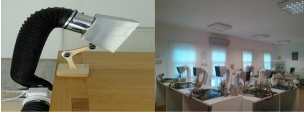
Görsel 4.10. Şaloma Havalandırma Sistemi ( https://www.cammalzeme.com/page.php?act=arama )
