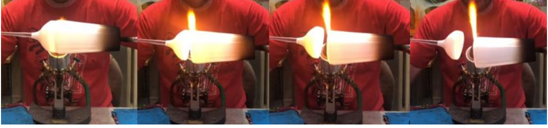
Görsel 5.37. Alevle ağız açma işlemi uygulama şekilleri ( https://www.instagram.com/p/B6EievFJEC3/ )
