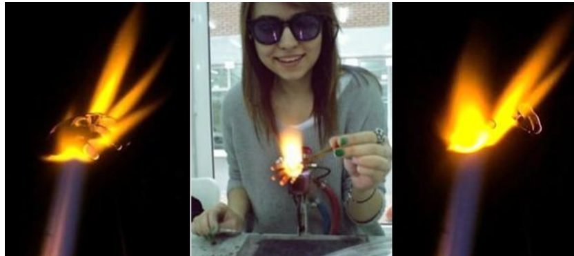
Görsel 6.6. Şalomada alevde cam Şekillendirme teknikleri uygulanarak borosilikat cam el yapım aşaması (B. Tosun Akın, 2021)
