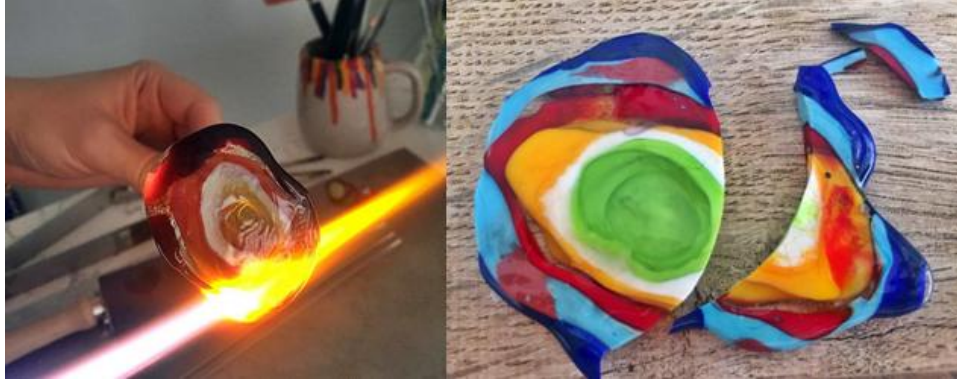
Görsel 6.4. Hatalı uygulama, termal genleşme katsayısı uyumsuz cam kullanımı (B. Tosun Akın, 2021)
