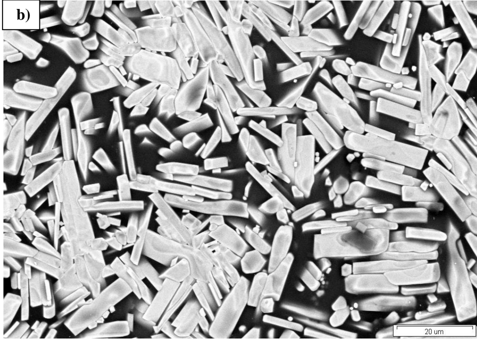
Şekil 5.52. Yb_2O_3+Sm_2O_3+CaO katkılı SiAlON seramiğinin 6 saat ısıtılma işlemi uygulandıktan sonra 1400^{\circ}C sıcaklık ve 72 saat süre boyunca sürtünme testine tabi tutulmuş numunesinin yüzeyinden (a) 500X ve (b) 3000X büyütme oranlarında alınmış SEM-BSE görüntüleri
