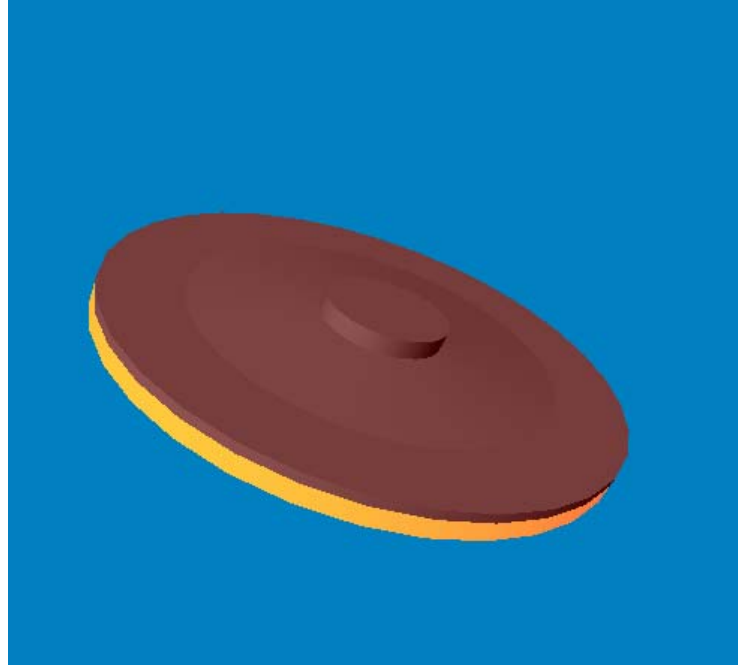
Şekil 6.43. Cymbal transdüserin üzerinde metal-polimer kütle kullanımının 3-D kesit gösterimi
