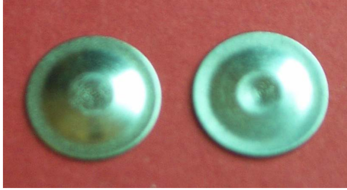
Şekil 5.2. Basınç altında plastik deformasyona uğramış metal kapaklar.
