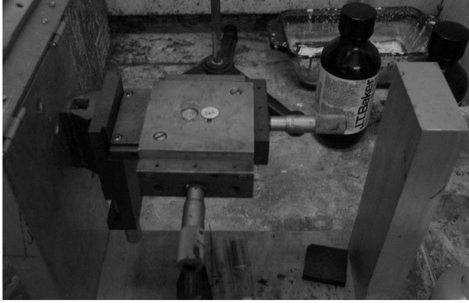
Şekil 3.2. Kapaklar seramik üstüne yerleştirilirken kullanılan ipek elek ve pozisyon ölçer
