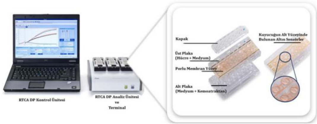
Şekil 4.3: Gerçek zamanlı hücre analiz sistemi (RTCA DP) modeli ve CIM-16 kodlu plakanın parçaları
