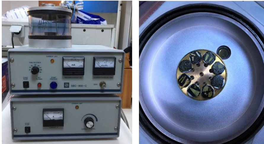
Şekil 3.3. Altın saçtırmalı kaplama cihazı ve hazırlanan örnekler
