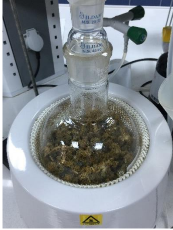
Şekil 3.7. B. nigra subsp. ruderalis uçucu yağ eldesi
