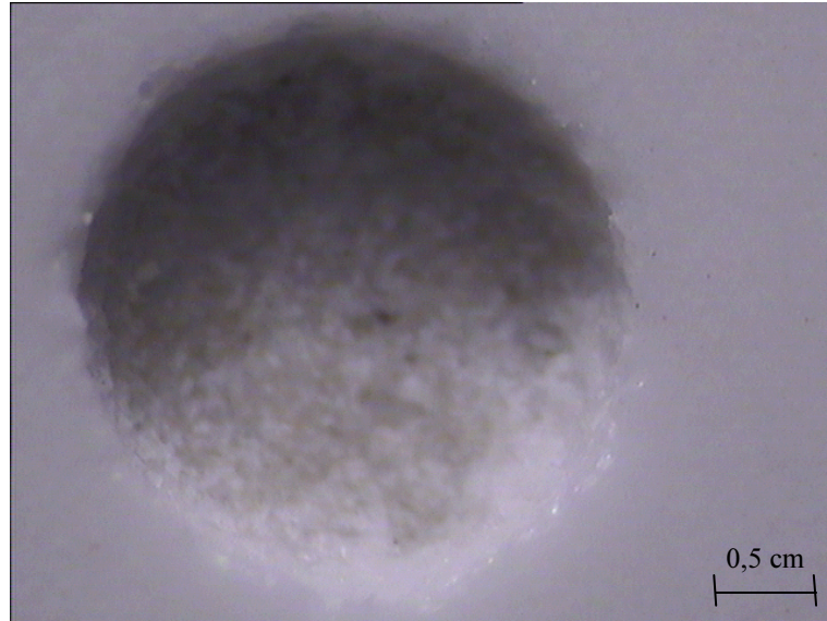
Şekil 6.68. Nd-YAG lazer kullanılarak açılan delik
