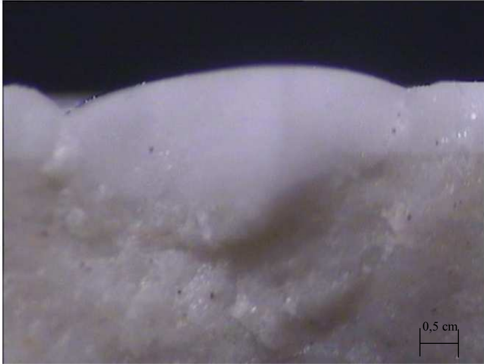
Şekil 6.86. Tamir bölgesi kesitinin optik mikroskop görüntüsü
