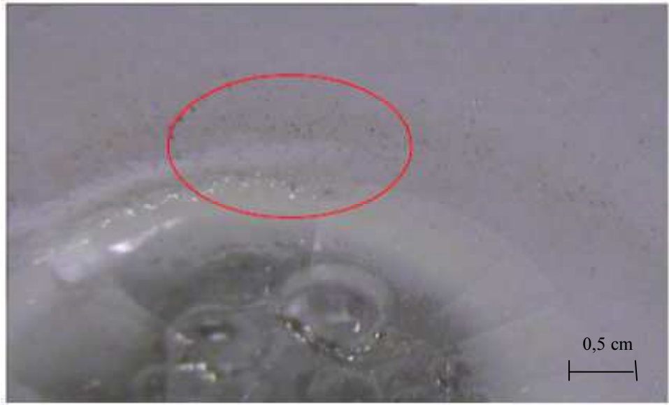
Şekil 6.75. CO 2 gazı birikmesi (Black core)
