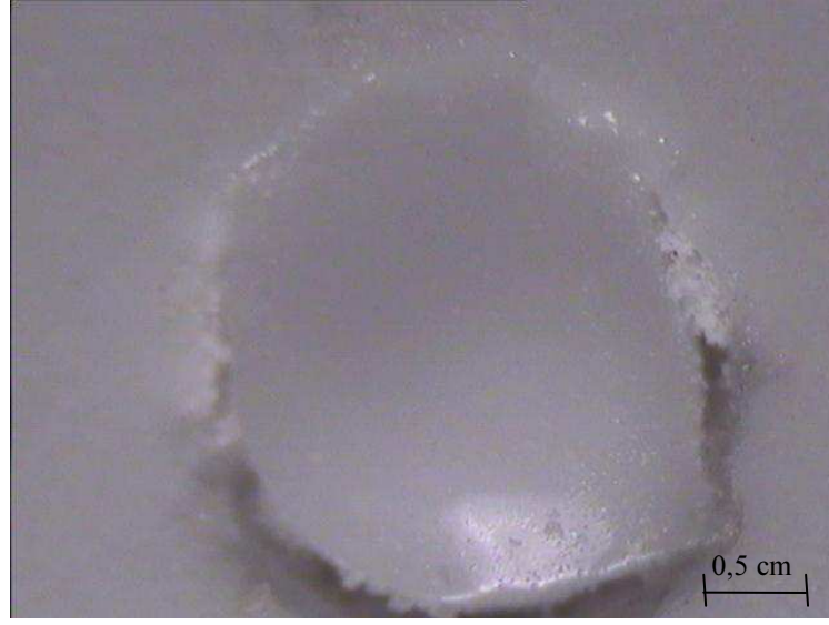
Şekil 6.71. Topaklanma “balling” hatası
