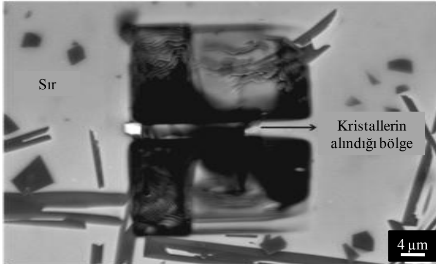
Şekil 4.71. FIB tekniği ile TEM numunesinin alınması sonrası SEM ile alınmış geri saçılımlı elektron (BSE) görüntüsü
