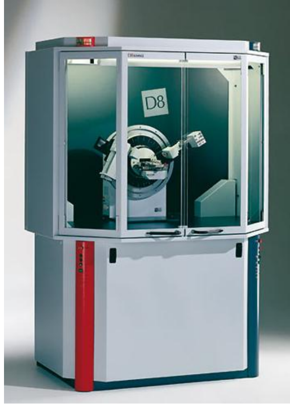
Şekil 4.2 Bruker D8 Advance cihazı
