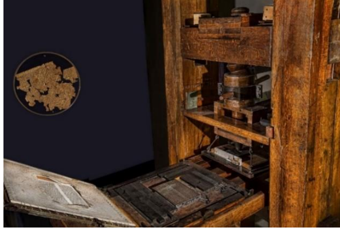
Görsel 1.12. Gutenberg'in icat ettiği baskı makinası. Hurufatlar tek tek yan yana dizilerek kelimeler, cümleler ve paragrafları oluşturuluyordu. Başlangıçta sadece kısa metinler basılabiliyordu. ( http://ev-forum-hanau.de , 24.11.2017)
