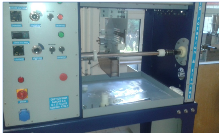
Görsel 3.1. Numune üretiminde kullanılan elyaf sarma cihazı
