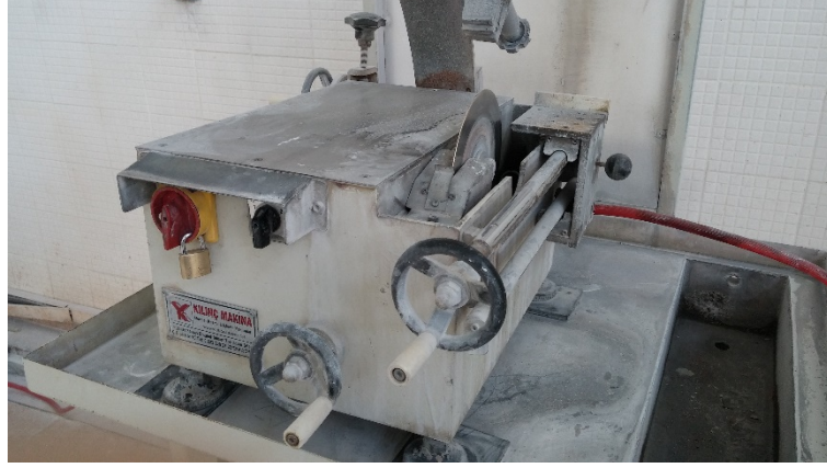
Görsel 3.9. Numune hazırlamada kullanılan sulu kesme cihazı
