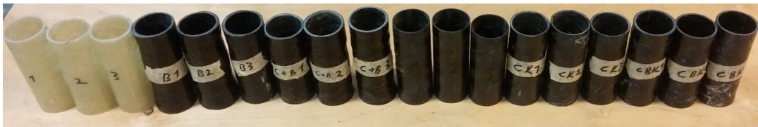
Görsel 3.11. ASTM D 2412 standardına uygun hazırlanmış numuneler
