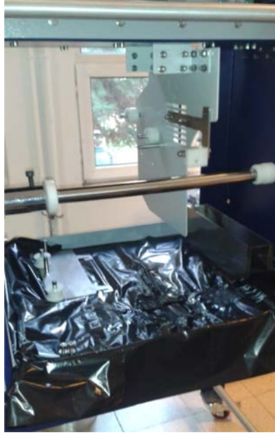
Görsel 3.2. Mandrel olarak kullanılan borunun elyaf sarma cihazına sabitlenmesi
