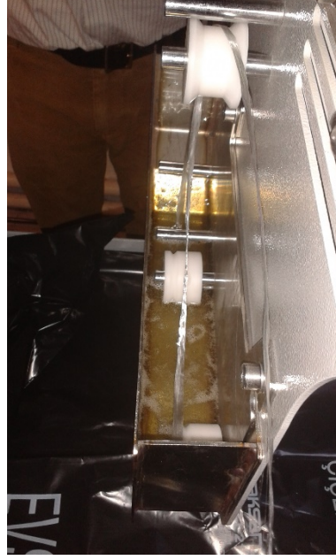
Görsel 3.4. Elyafın reçine havuzunda ıslatılması
