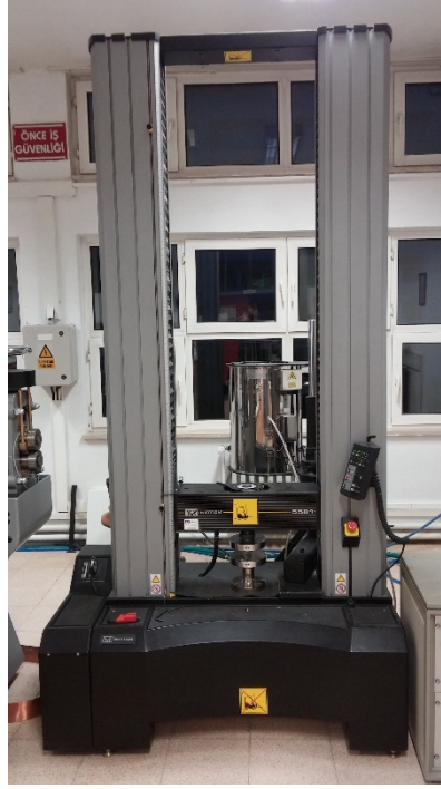
Görsel 3.12. Testlerde kullanılan Instron 5581 cihazı
