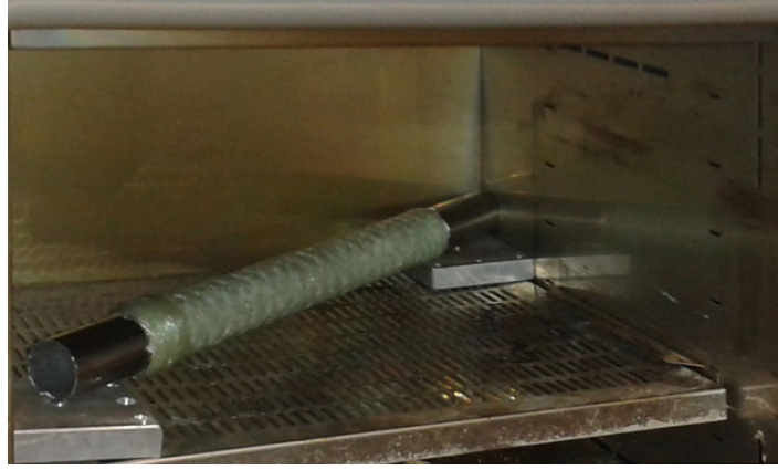
Görsel 3.7. 60 °C sıcaklıkta post-kürlenmiş cam elyaf takviyeli numune
