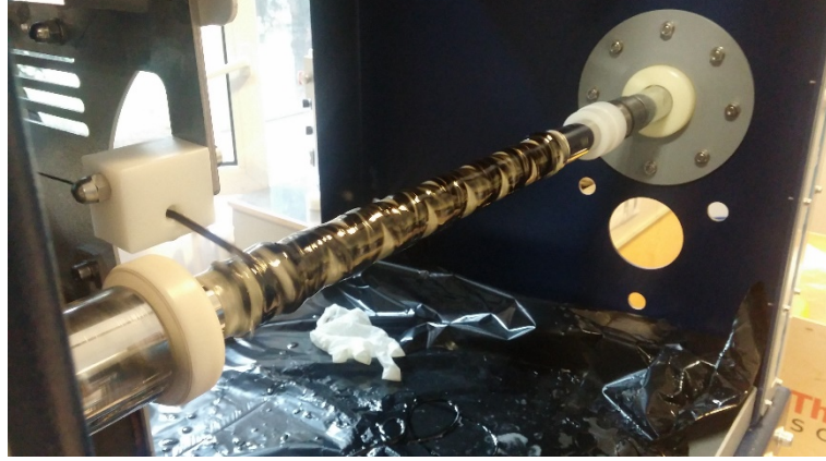
Görsel 3.5. Cam ve karbon elyaflardan oluşan melez kompozit silindir üretimi
