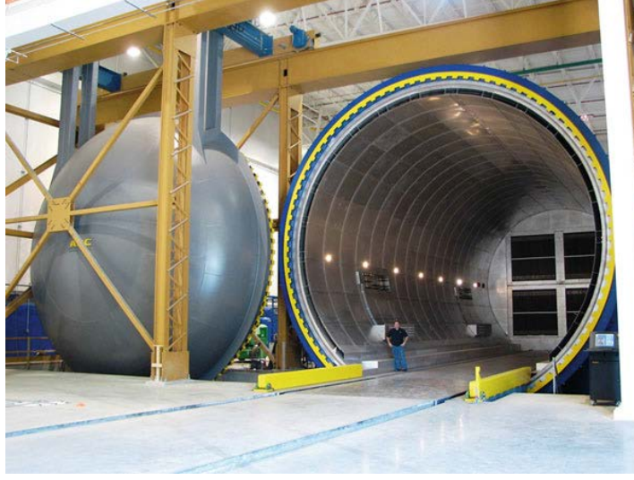
Görsel 2.10. Kompozit üretiminde kullanılan bir otoklav örneği [20]
