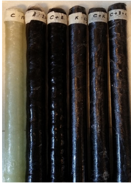
Görsel 3.8. Farklı elyaflar ile takviyelenmiş numuneler
