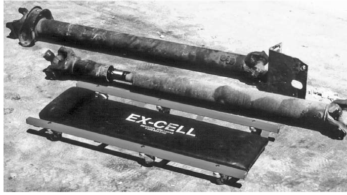
Görsel 2.8. Tek parça (üstte) ve iki parça (altta) kardan mili örnekleri [32]
