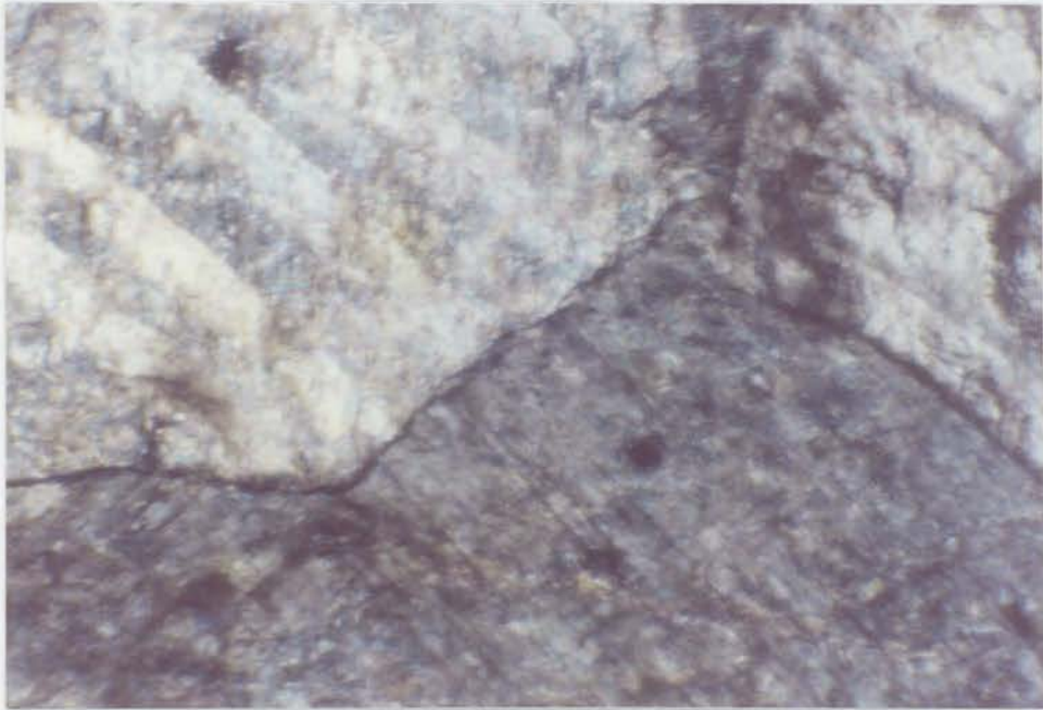
Şekil 6.6. Kalsit kristalinde dilinim, çokuzlar ve dişli kenetlenme şekli
