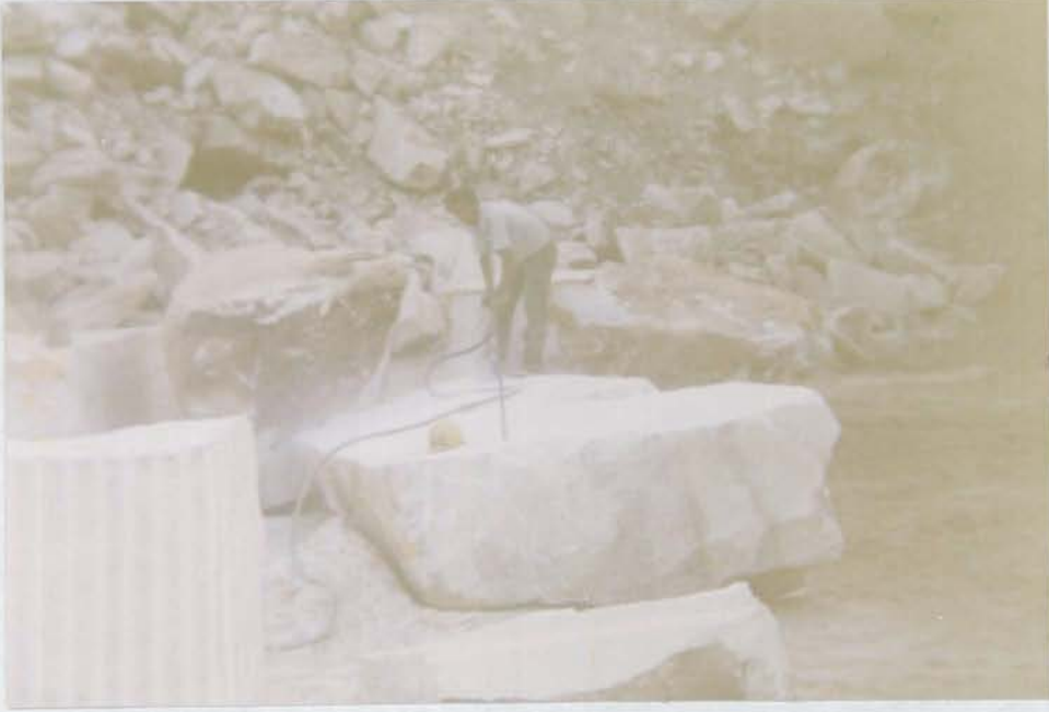
Şekil 12.19. Yıkılan bir bloğun sayalama işlemi
