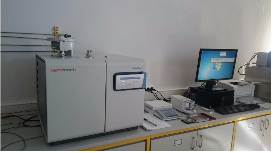
Şekil Ek 9. ThermoScientific FlashSmart Elementel Analiz Cihazı
