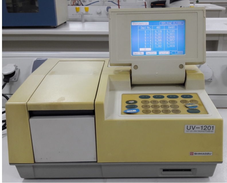
Şekil Ek 4. SHIMADZU UV-1201 spektrofotometre
