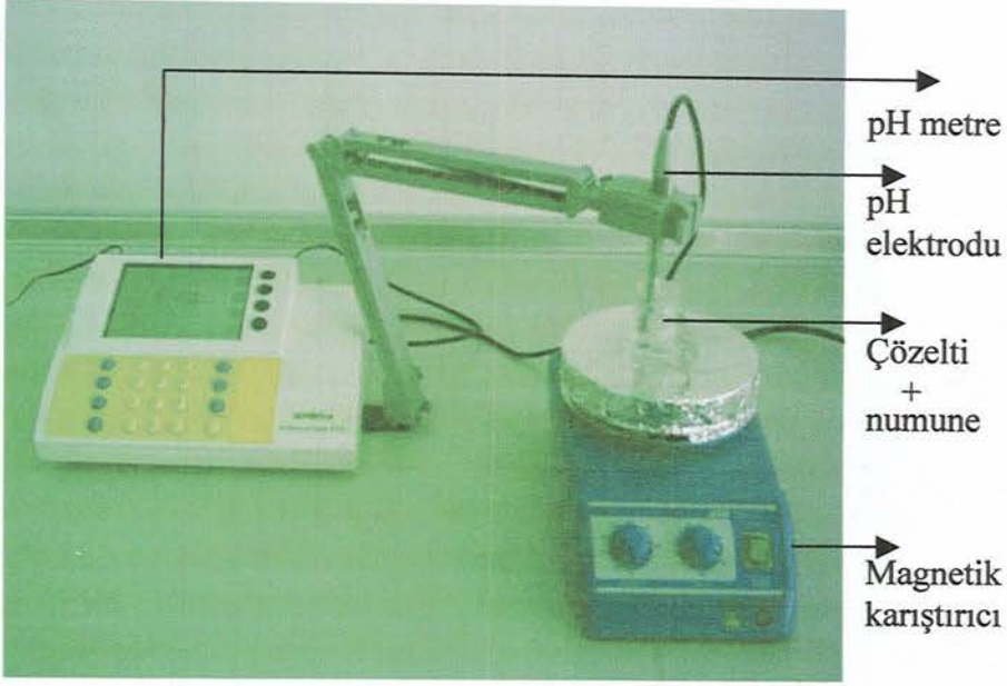
Şekil 9.8. pH ölçümlerinin alındığı düzenek
