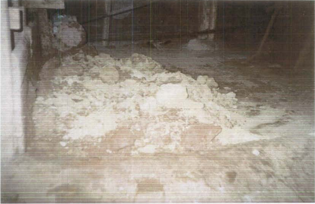
Şekil 3.11. Ocaktan gelen toprağın ıslatılıp dinlendirilmesi
