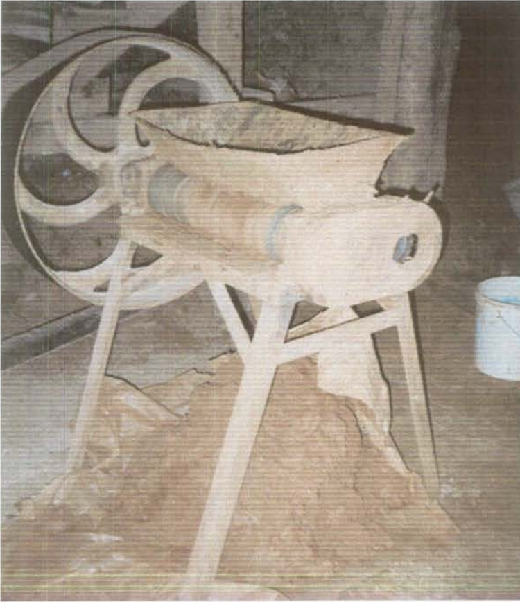
Şekil 3.12. Islatılmış toprağın valsli ezme makinesinden geçirilmesi
