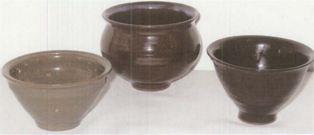
Şekil 6.48. ÇÇ kilinden çömlekçi tornasında şekillendirilmiş, sırlandıktan sonra 1200°C’de sır pişirimi yapılmış örnekler
