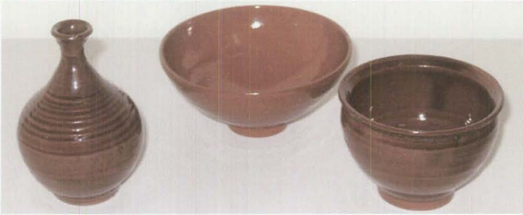
Şekil 6.47. ÇÇ kilinden çömlekçi tornasında şekillendirilmiş, sırlandıktan sonra 1000°C’de sır pişirimi yapılmış örnekler
