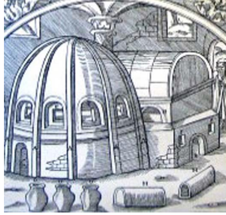
Görsel 2.11. Ön kısımda bulunan fırın ergitme işleminin yapıldığı kısım arka kısımda bulunan fırın ise tavlama fırınıdır.
