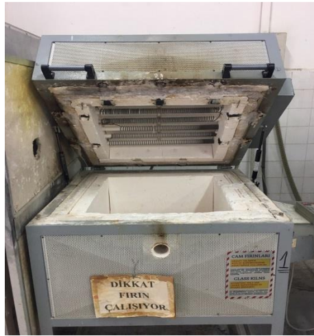
Görsel 4.4. Kalıplar için kullanılan fırın ( Ecem Yılmaz fotoğraf arşivi )
