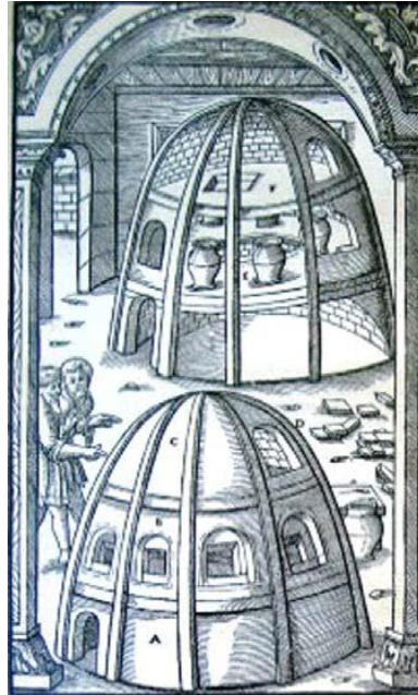
Görsel 2.12. iki ayrı cam fırını, öndeki ergitme fırını arkadaki ise tavlama fırını
