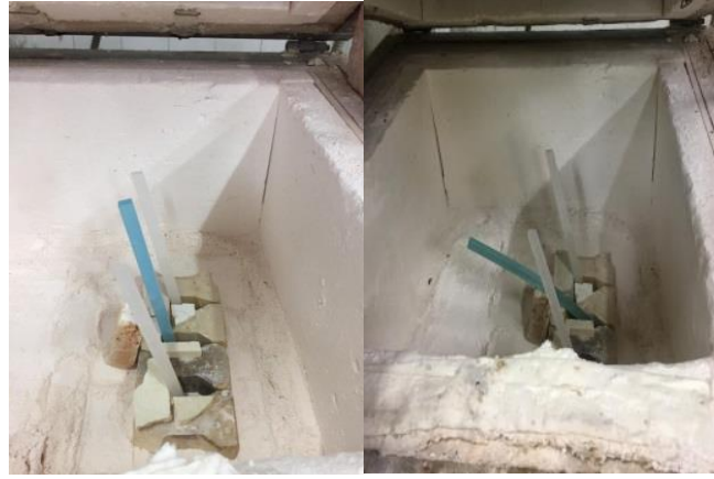
Görsel 4.40. İnce cam çubuklara tavlama sıcaklıkları için ısı işlem uygulanıyor (Ecem Yılmaz fotoğraf arşivi )
