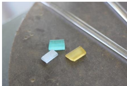
Görsel 4.7. Camların küçük boyutlarda kesilmiş hali ( Ecem Yılmaz fotoğraf arşivi )
