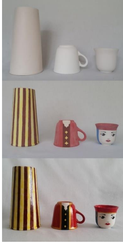
Görsel 3.18. “Anadolu Serisi”, Bisküvi, dekorlu ve sırlı ürünlerin yapım aşamaları (Müge Arın fotoğraf arşivi, 2021)
