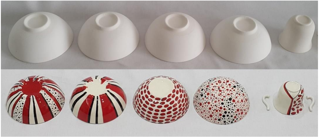
Görsel 3.16. “Türkan Serisi”, Bisküvi ve sırlı ürünlerin yapım aşamaları (Müge Arın fotoğraf arşivi, 2019)
