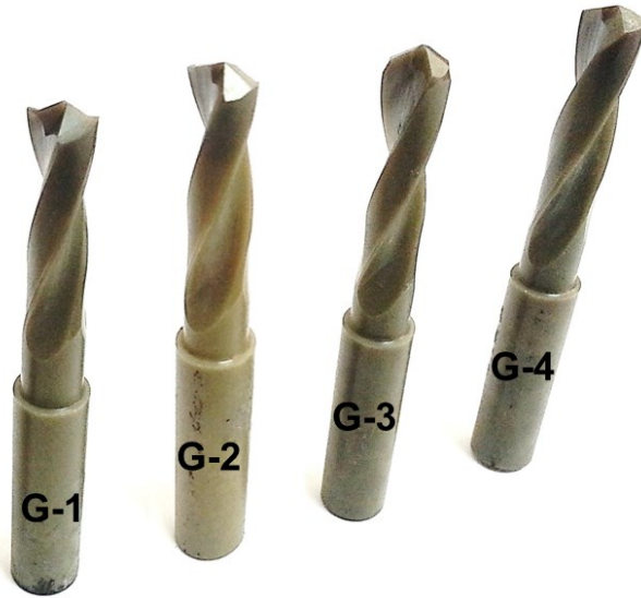
Şekil 8.3. Taşlama sonrasında SiAlON matkap uçlarının görüntüleri
