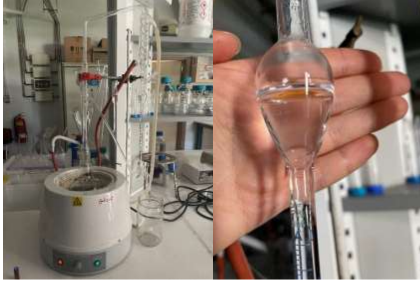
Görsel 3.3. Clevenger aparatı ve uçucu yağ eldesi
