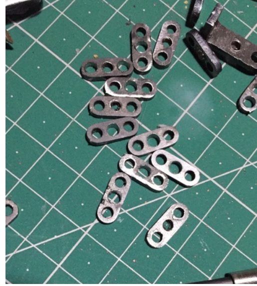
Görsel 3. 24. Uygulama filmindeki karakterlerin eklemlerini oluşturacak armetür çizimi ve kesim aşaması (Semih Özaniş kişisel arşivi)
