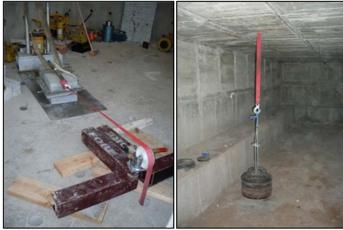
Şekil 3.14. Statik sürtünme katsayısı deney düzeneği
