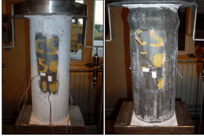
Şekil 4.35. CS5010 numunesi deney öncesi ve sonrası
