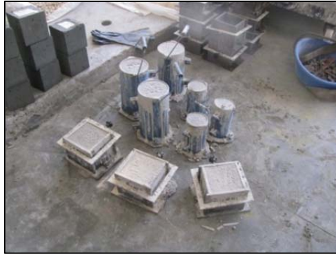
Şekil 3.8: Dayanım ve elastisite modülü tespiti için dökülen beton numuneleri
