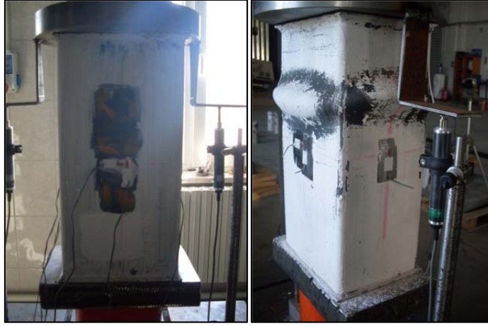
Şekil 4.131. RS5010 numunesi deney öncesi ve sonrası
