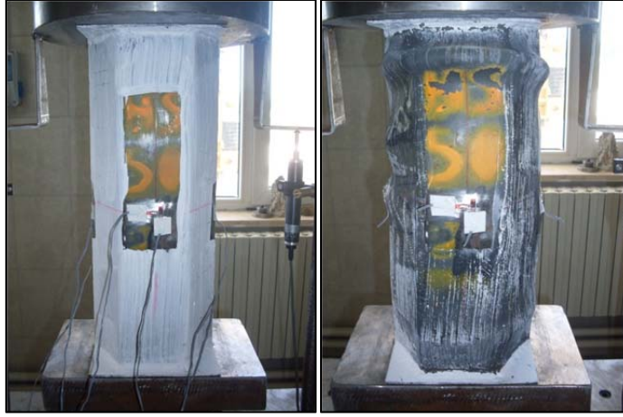
Şekil 4.89. HS5030 numunesi deney öncesi ve sonrası
