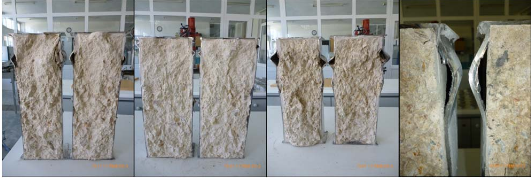
Şekil 6.12. 1.50 mm ve 3.00 mm cidar kalınlığına sahip daire, altıgen kesitler ile tüm dikdörtgen ve kare kesitlerde çelik tüpün betondan bağımsız gösterdiği burkulma davranışı
