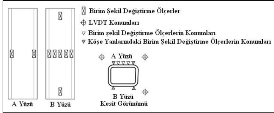
Şekil 2.8. Birim Şekil Değişirme Ölçerler ve LVDT 'lerin numune üzerindeki konumları
