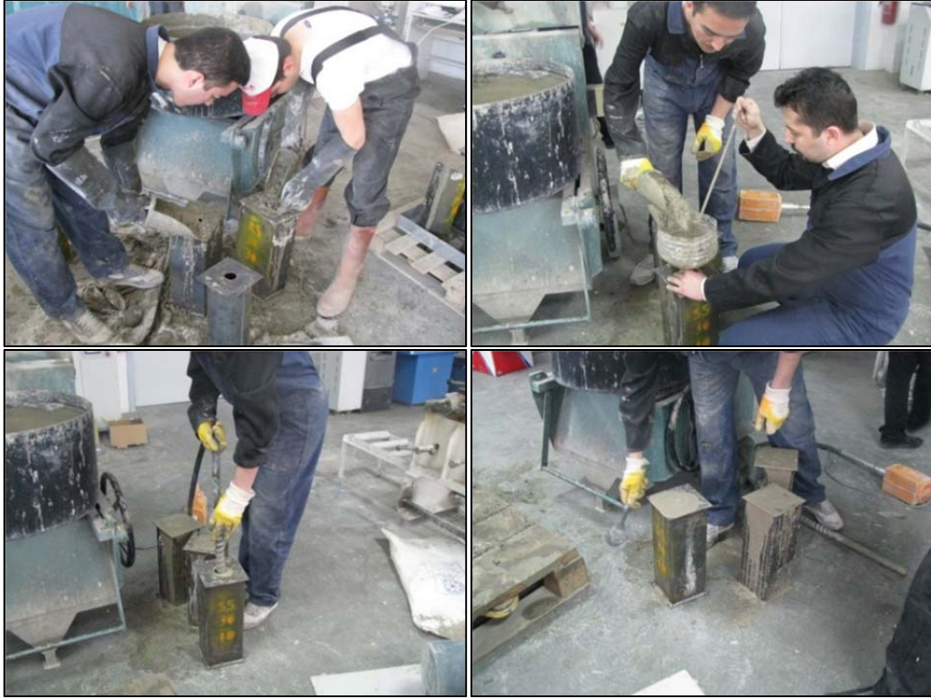
Şekil 3.23. Çelik numunelerinin içerisine beton dökümü
