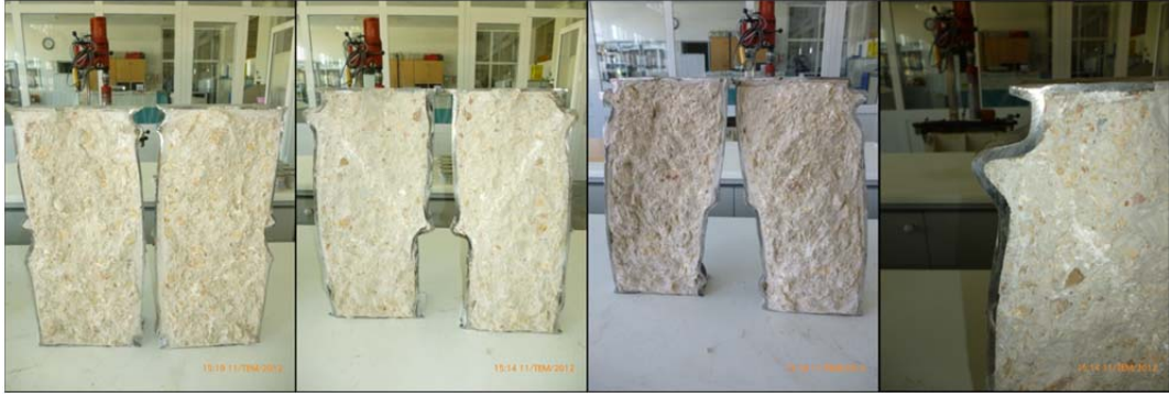
Şekil 6.13. 5.00 mm ve 8.00 mm cidar kalınlığına sahip daire ile altıgen kesitlerde çelik tüpün betonla birlikte gösterdiği burkulma davranışı
