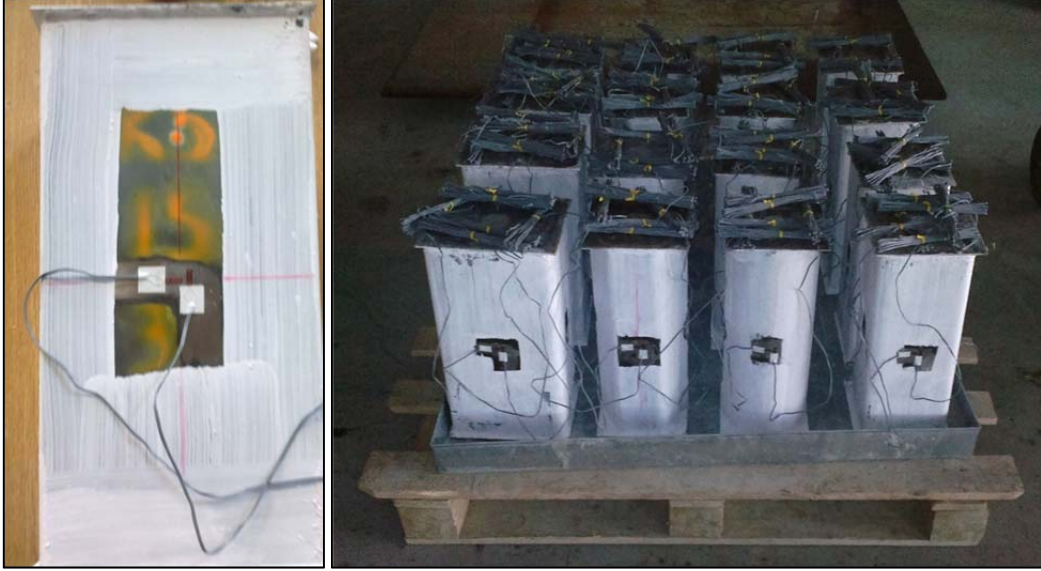
Şekil 3.32. Birim şekil değiştirme ölçer ve CFST numunelerin kırılmadan önceki son hali
