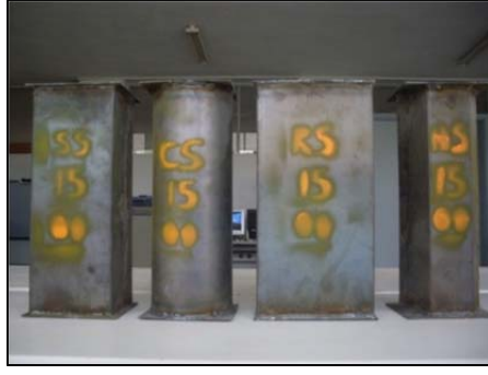
Şekil 3.22. Çelik numuneler (sırasıyla kare, dairesel, dikdörtgen ve altıgen kesitler)
