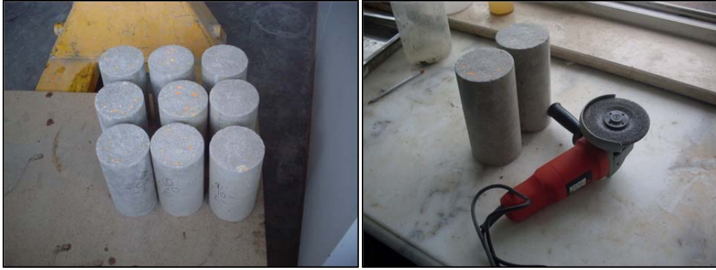
Şekil 3.3. Elastisite modülü beton numune başlıklarının düzlenmesi
