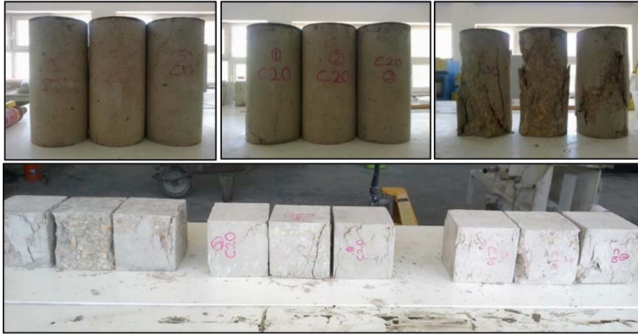
Şekil 4.1. C10, C20, C30 silindir ve küp numunelerin beton basınç deneyinden sonraki durumları
