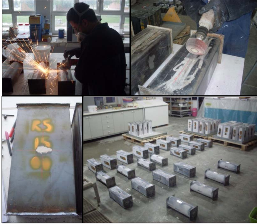
Şekil 3.27. Birim Deformasyon Ölçerlerin Konumlarının Belirlenmesi ve Kireçleme
