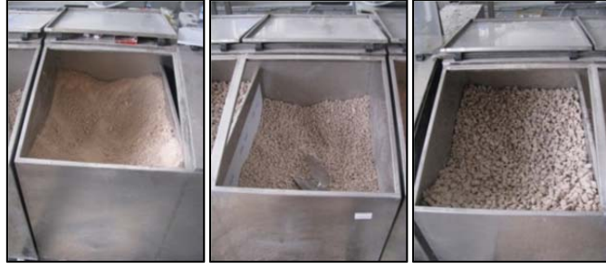
Şekil 3.1. Tasarımda kullanılan agregalar (Sırasıyla 0-5mm, 5-15mm ve 15-22mm)
