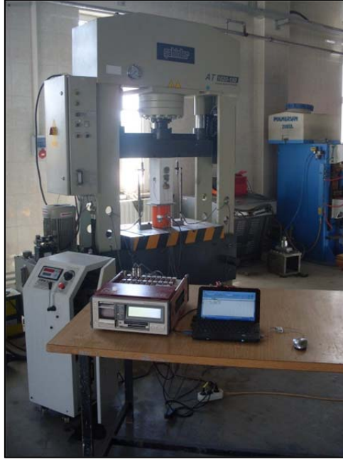
Şekil 3.33: CFST eksenel basınç deney düzeneği
