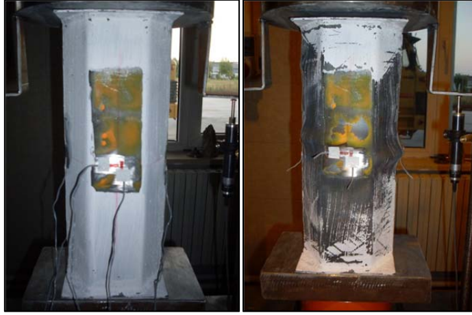
Şekil 4.74. HS3020 numunesi deney öncesi ve sonrası
