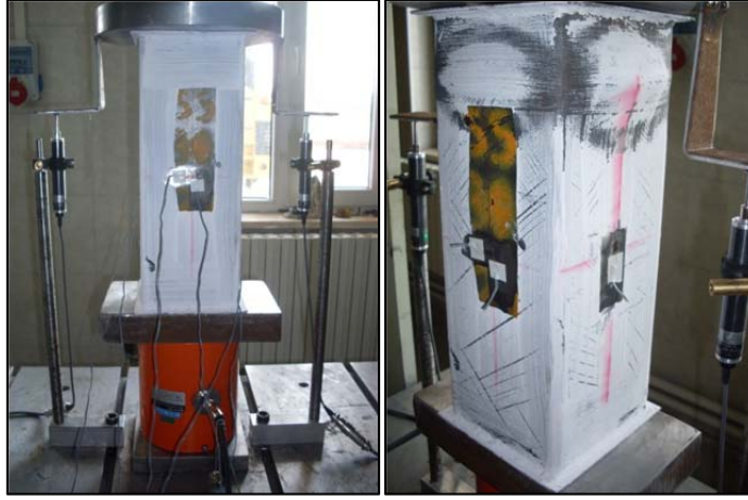
Şekil 4.170. SS3020 numunesi deney öncesi ve sonrası
