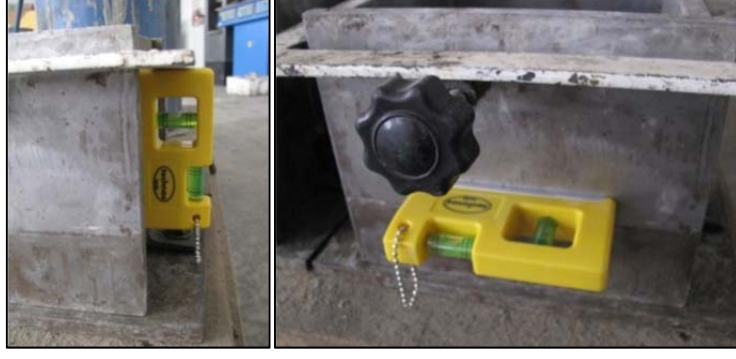
Şekil 3.6. Kalıp şakülünün kontrolü
