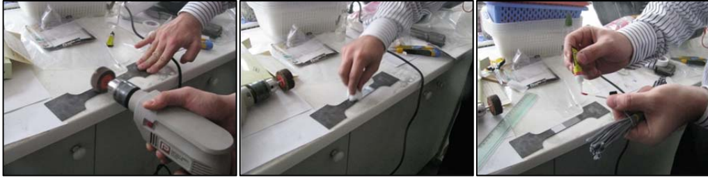
Şekil 3.11. Birim şekil değiştirme ölçer (strain gauge) yapıştırma aşamaları
