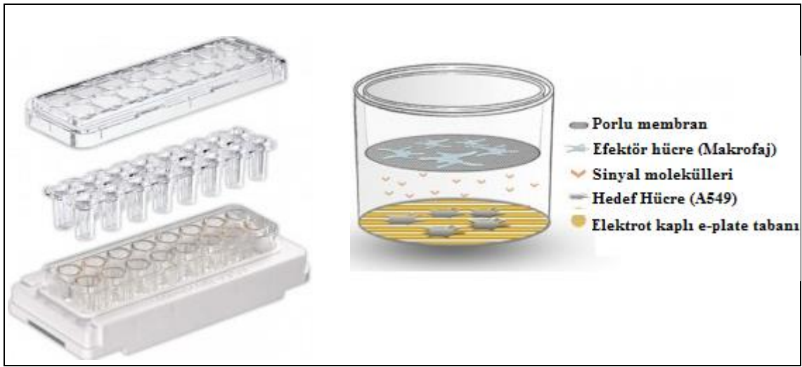
Şekil 4.2. E-plate insert plakasının şematik olarak gösterilmesi.
