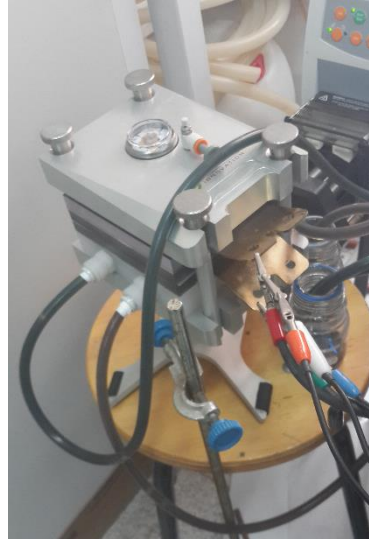
Şekil 3.3. FB-25 (Greenlight, Canada) model akışkan batarya test hücresi
