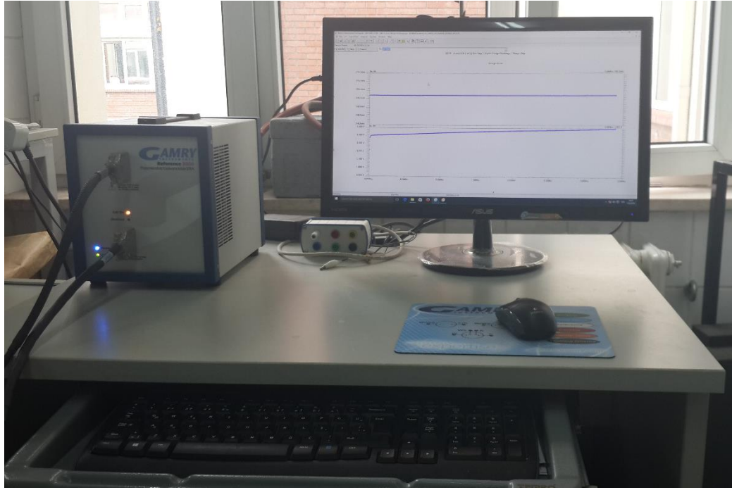
Şekil 3.2. Gamry marka Reference 3000 model potantiyostat/galvanostat cihazı
