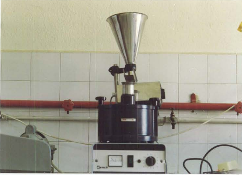
Şekil 3.1. Materyalin Öğütülmesinde Kullanılan Değirmen
