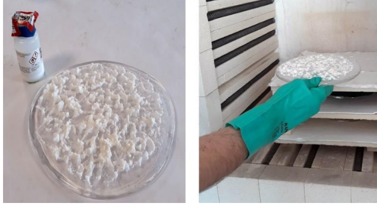
Şekil 7.56. Fırınlamaya Hazır Karışım ve Fırınlanması
