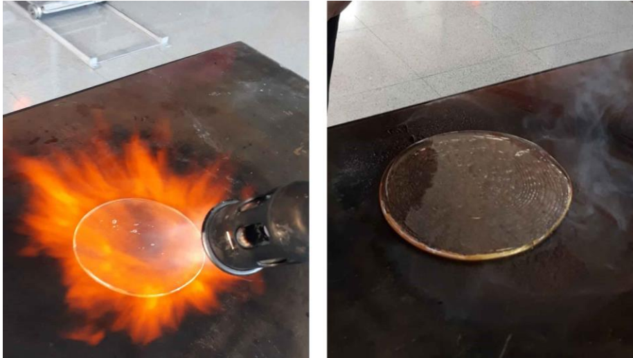
Şekil 7.5. (a) Camın Pürmüz Yardımı ile Isısının Dengelenmesi (b) Tavlamaya Hazır Plaka
