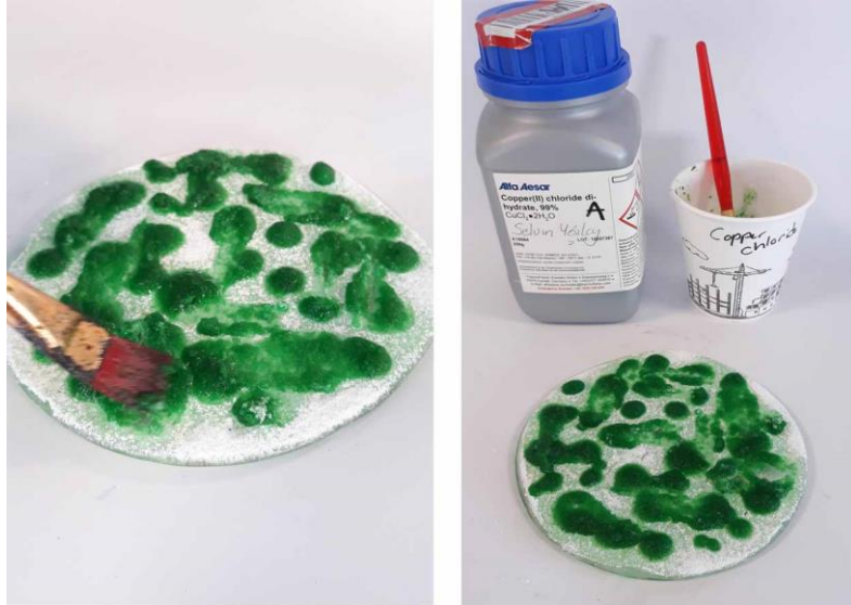
Şekil 7.67. Plakaya Karışımın Uygulanması ve Hazırlanmış Plaka
