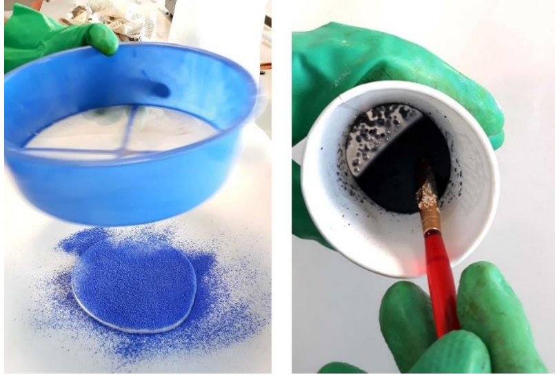
Şekil 7.24. Cam Plakanın Toz ile Kaplaması ve Hazırlanmış Karışım
