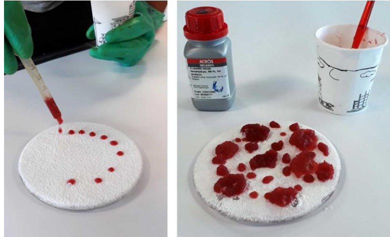
Şekil 7.11. Hazırlanan Karışımın Uygulanması ve Fırınlamaya Hazır Hali
