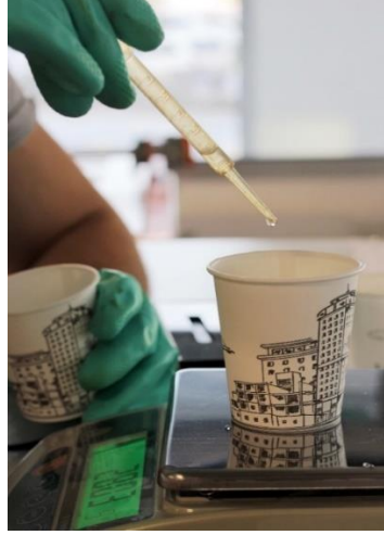
Şekil 7.48. Karışıma Su Eklenmesi
