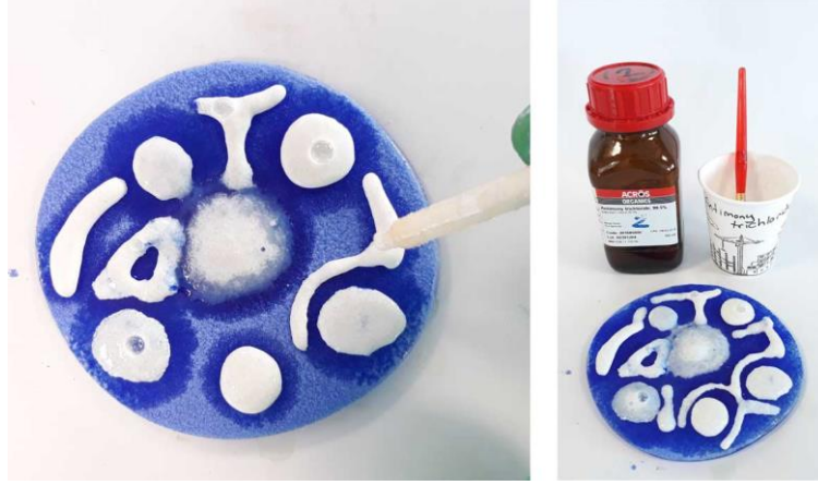
Şekil 7.53. Hazırlanan Karışımın Uygulanması ve Fırınlamaya Hazır Plaka
