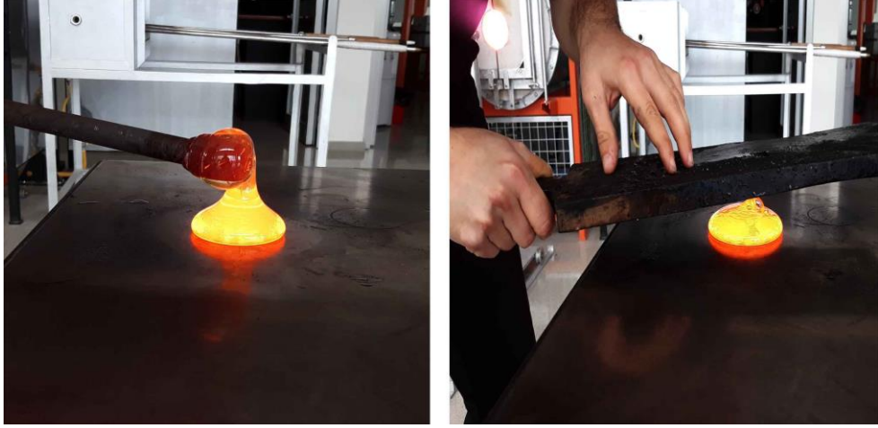
Şekil 7.4. (a) Camın Pipodan Koparılması (b) Ahşap Yardımı ile Ezilmesi
