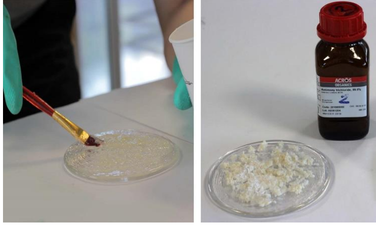
Şekil 7.49. Karışımın Yüzeye Sürülmesi ve Fırınlamaya Hazır Plaka
