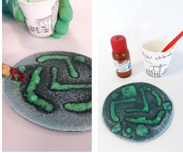
Şekil 7.39. Hazırlanan Karışımın Uygulanması ve Fırınlamaya Hazır Plaka
