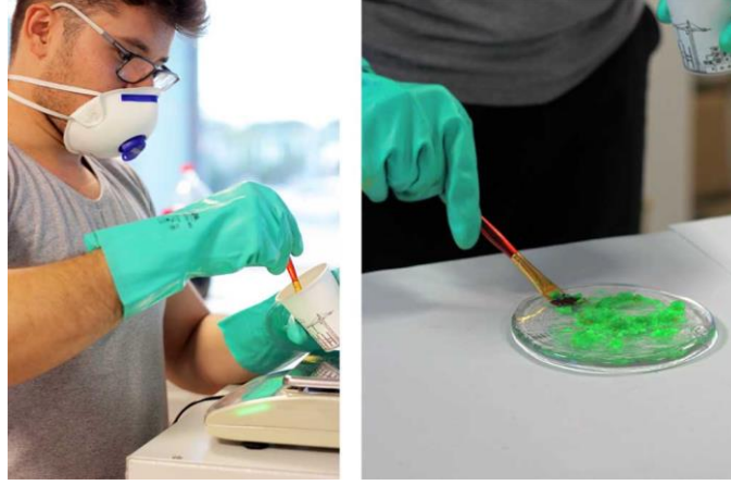
Şekil 7.34. Hazırlanan Karışımın Terazi ile Tartılması ve Cam Plakaya Uygulanması
