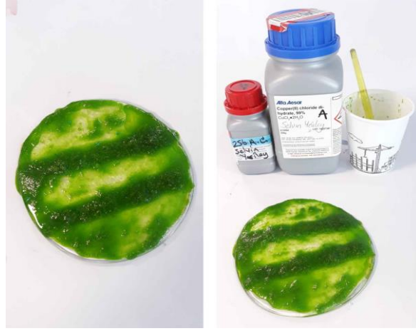
Şekil 7.73. Uygulanmış ve Fırınlamaya Hazır Plaka
