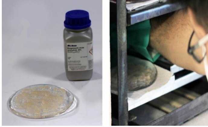
Şekil 7.14. Manganez (II) Nitrat Tetrahidrat Karışımı Uygulanmış Cam Plaka ve Fırına Yerleştirilmesi
