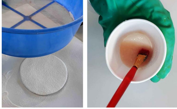
Şekil 7.17. Kevgir Yardımı ile Tozlanması ve Hazırlanmış Karışım
