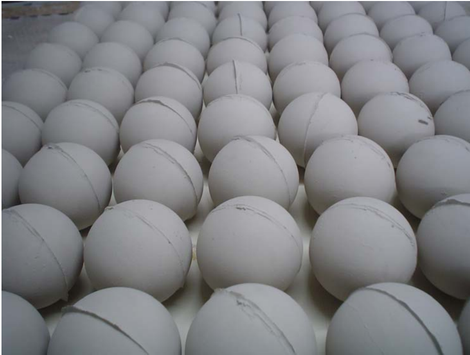
Resim 151. Dökümlerin kalıptan çıkarıldıktan sonra kurumaya bırakılması.
