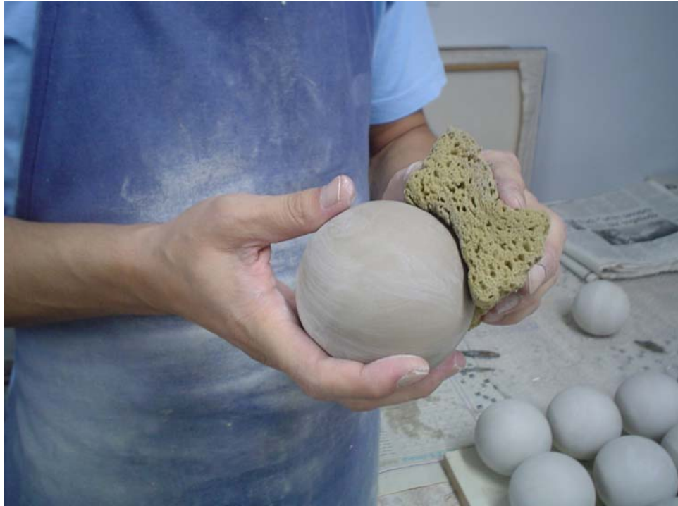
Resim 153. Dökümlerin rötuşlarının yapılması.
