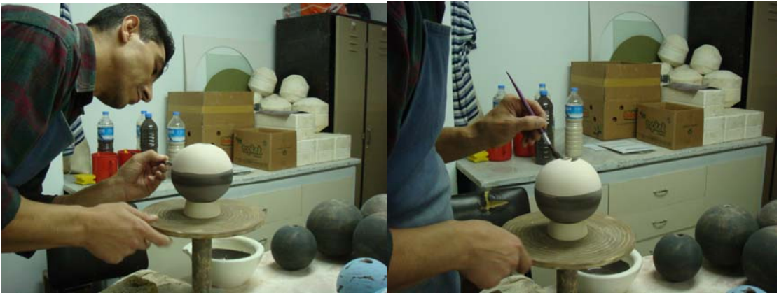
Resim 160,161. Ürünlerin fırça ile sır ve dekorlarının yapılması.
