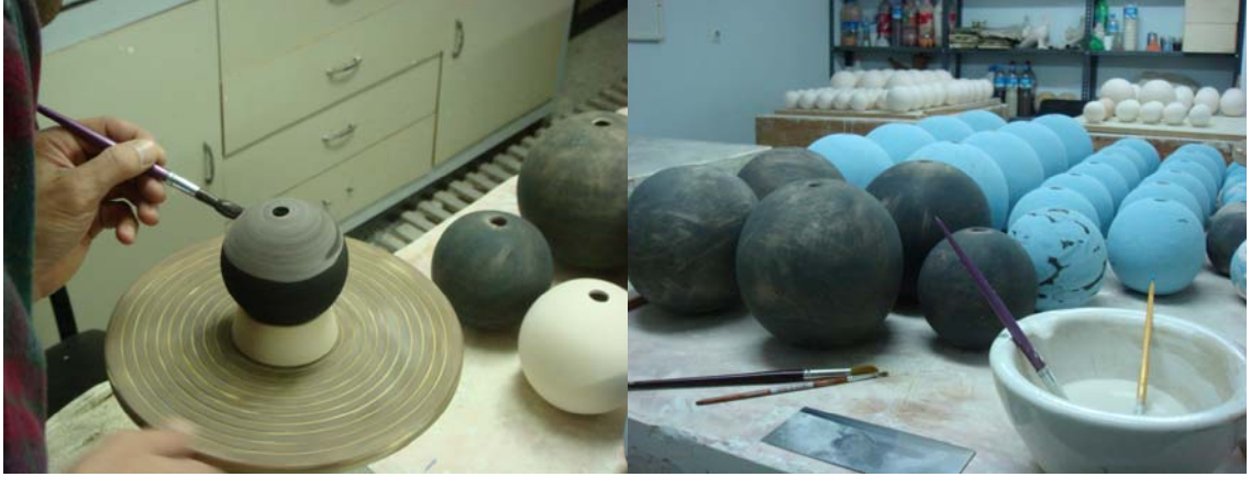
Resim 164,165. Ürünlerin fırça ile sır ve dekorlarının yapılması.
