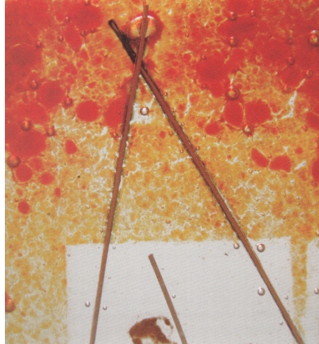
Görsel 2.13. Füzyon- İki Cam Arasında Kullanılan Cam Çubuklar ve Oluşmuş Hava Kabarcıkları (Watkins-Baker, 2010, s. 82)
