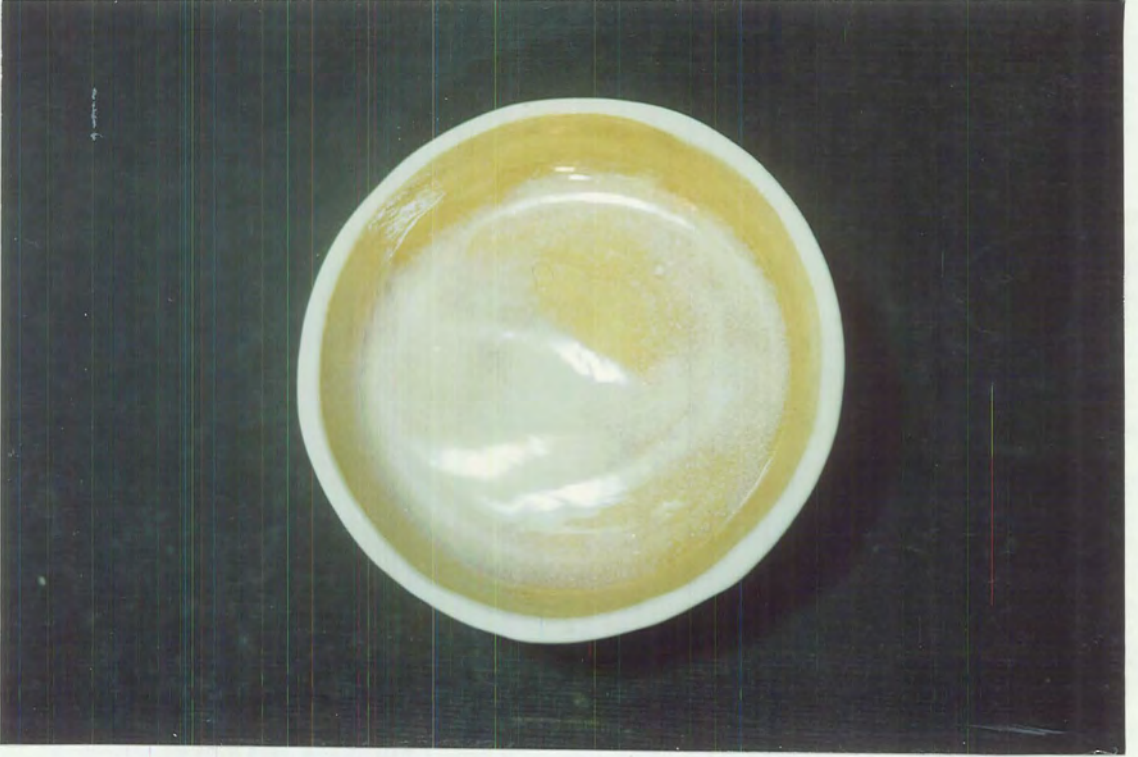
Resim: 12 1000 °C'de Pişirilmiş Fritli Bünye İle Hazırlanan Lüsterli Sır Denemesi Çap: 8 cm.
