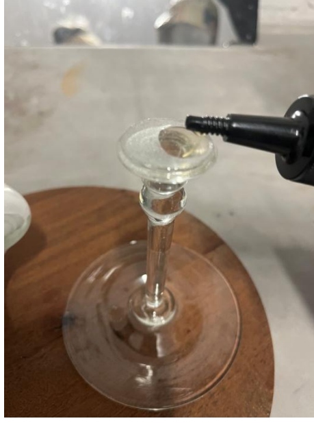
Görsel 5. 57. Cam yüzeye yapıştırıcı uygulanması (İrem Yılmaz fotoğraf arşivi)
