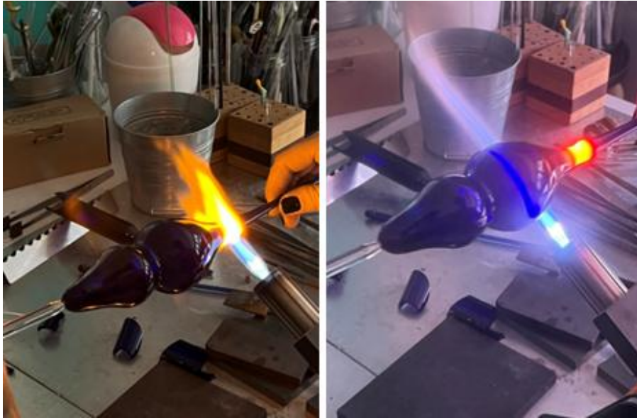
Görsel 5. 5. Cam tüpteki sapın çıkartılması (İrem Yılmaz fotoğraf arşivi)
