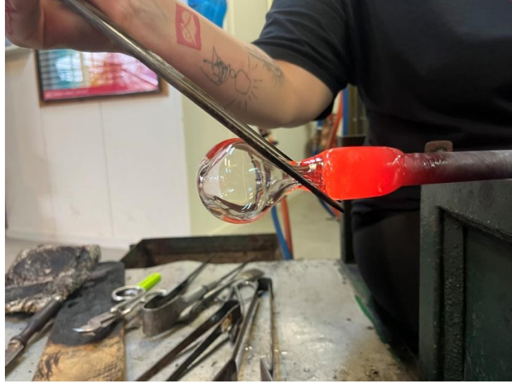
Görsel 5. 44. Kadeh ayağının şekillendirilmesi (İrem Yılmaz fotoğraf arşivi)
