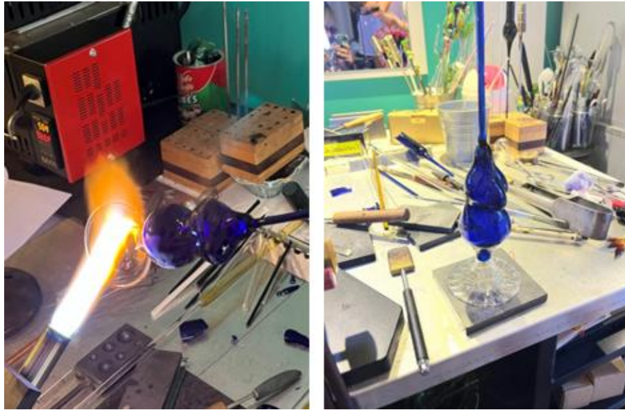
Görsel 5. 12. Kadeh ayağının açılması ve kontrol edilmesi (İrem Yılmaz fotoğraf arşivi)
