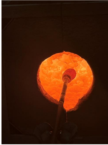
Görsel 5. 37. Tromel fırınında camın ısıtılması (İrem Yılmaz fotoğraf arşivi)
