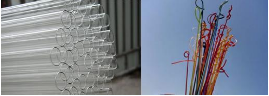
Görsel 3. 20. Şeffaf borosilikat tüp ve soda camı renkli çubuk örnekleri
