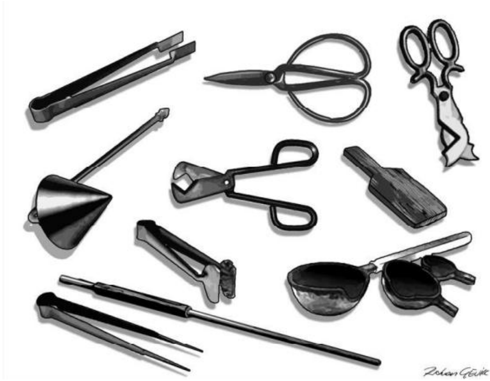
Görsel 3. 8. Sıcak cam şekillendirmede kullanılan en yaygın el aletleri. İllustrasyon: Rıdvan Çelik (E. Kula 2005)
