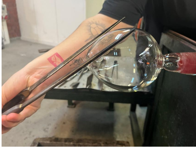
Görsel 5. 28. Kadeh haznesinin şekillendirilmesi (İrem Yılmaz fotoğraf arşivi)
