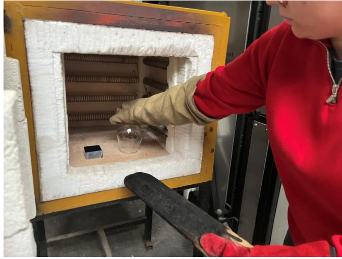
Görsel 5. 51. Kadeh kabının tavlama fırınından alınması (İrem Yılmaz fotoğraf arşivi)
