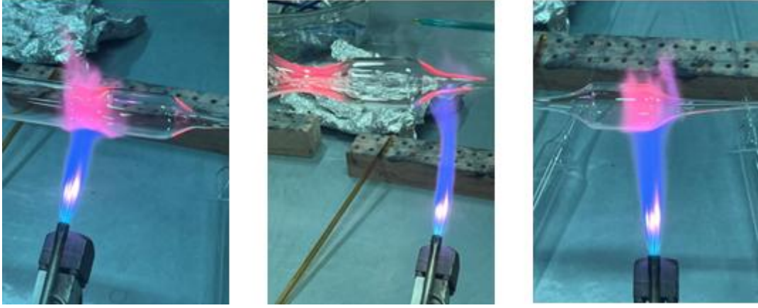
Görsel 3. 22. Borosilikat cam tüpün sap çekme aşaması. (İrem Yılmaz fotoğraf arşivi)
