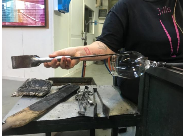
Görsel 5. 34. Kadeh haznesinin şekillendirilmesi (İrem Yılmaz fotoğraf arşivi)
