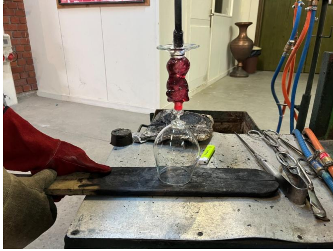
Görsel 5. 52. Kadeh kabının gövde ile sıcak birleştirilmesi (İrem Yılmaz fotoğraf arşivi)
