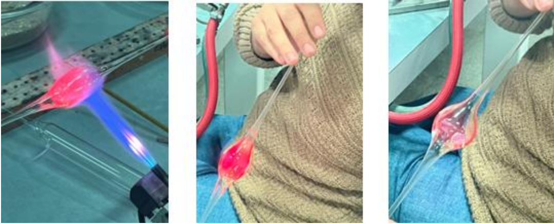
Görsel 3. 23. Cam tüpün üflenme aşaması. (İrem Yılmaz fotoğraf arşivi)
