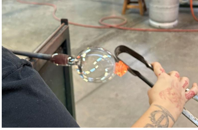
Görsel 5. 30. Bağlantı parçası ekleme (İrem Yılmaz fotoğraf arşivi)
