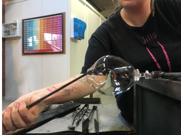
Görsel 5. 33. Kadeh haznesinin ağzının şekillendirilmesi (İrem Yılmaz fotoğraf arşivi)
