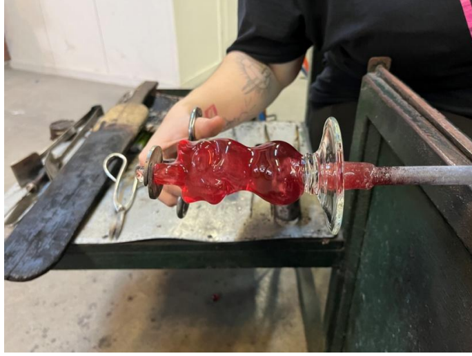
Görsel 5. 50. Figüratif kadeh gövdesinin nobleye aktarılması (İrem Yılmaz fotoğraf arşivi)
