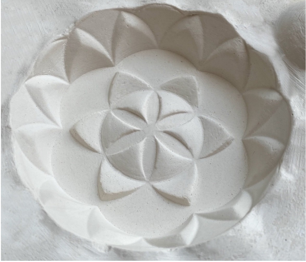
Görsel 3.16. Yaşam Çiçeği Bardağın alt kalıp parçası Sümeyye Karakuş fotoğraf arşivi
