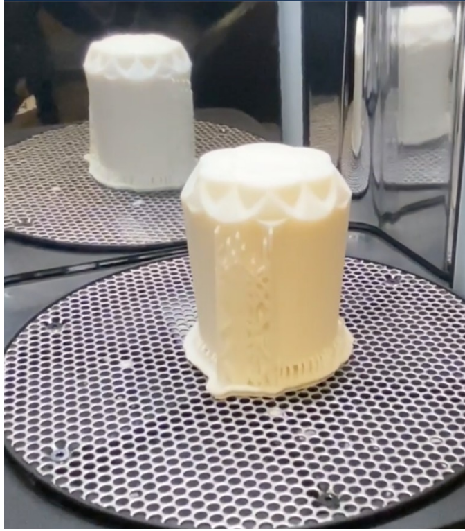
Görsel 2.16. Kürlleme cihazında sertleşen model Sümeyye Karakuş fotoğraf arşivi
