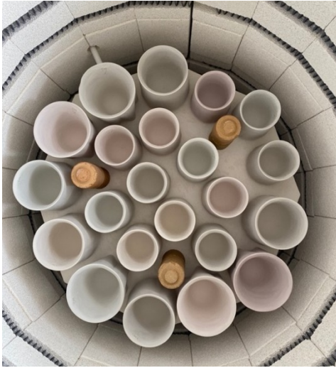
Görsel 3.39. Ürünlerin bisküvi ve ardından sırlı pişirim için fırına yüklenmesi Sümeyye Karakuş fotoğraf arşivi
