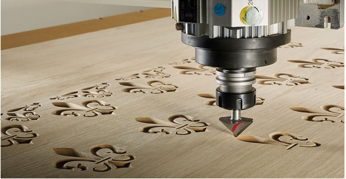
Görsel 1.10. CNC teknolojisi ile ahşap kazıma ( http-13 )
