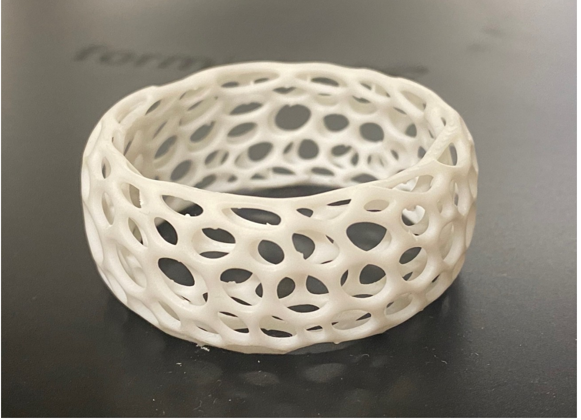
Görsel 2.3. İnce detaylı bir tasarımın SLA baskı örneği Sümeyye Karakuş fotoğraf arşivi
