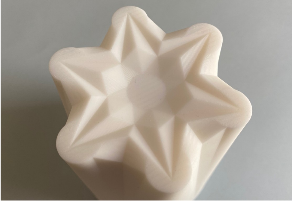
Görsel 2.19. SLA yöntemi ile üretilen model ürün Sümeyye Karakuş fotoğraf arşivi
