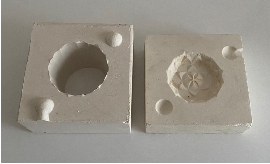
Görsel 3.35. Gövde kalıbının tamamlanmış hali Sümeyye Karakuş fotoğraf arşivi
