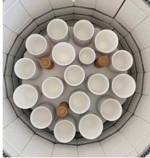
Görsel 3.39. Ürünlerin bisküvi ve ardından sırlı pişirim için fırına yüklenmesi Sümeyye Karakuş fotoğraf arşivi
