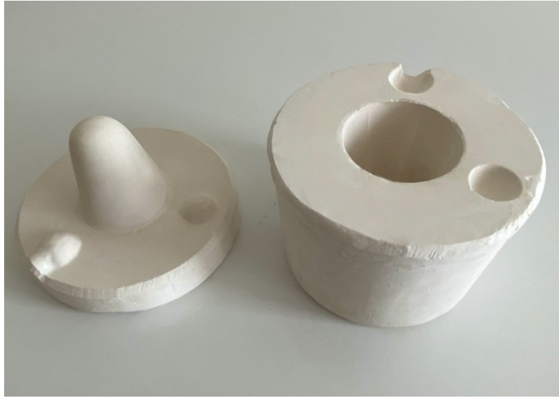
Görsel 3.20. Metatron bardağın kalıp parçaları Sümeyye Karakuş fotoğraf arşivi
