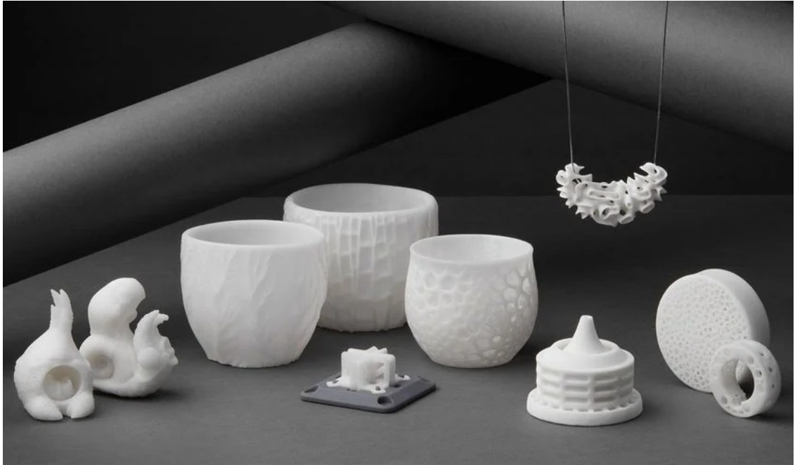
Görsel 2.4. SLA ile basılan seramik ürünler (http-18)
