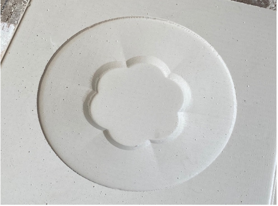
Görsel 2.44. Kazıma işlemi tamamlanan tabak kalıbı Sümeyye Karakuş fotoğraf arşivi
