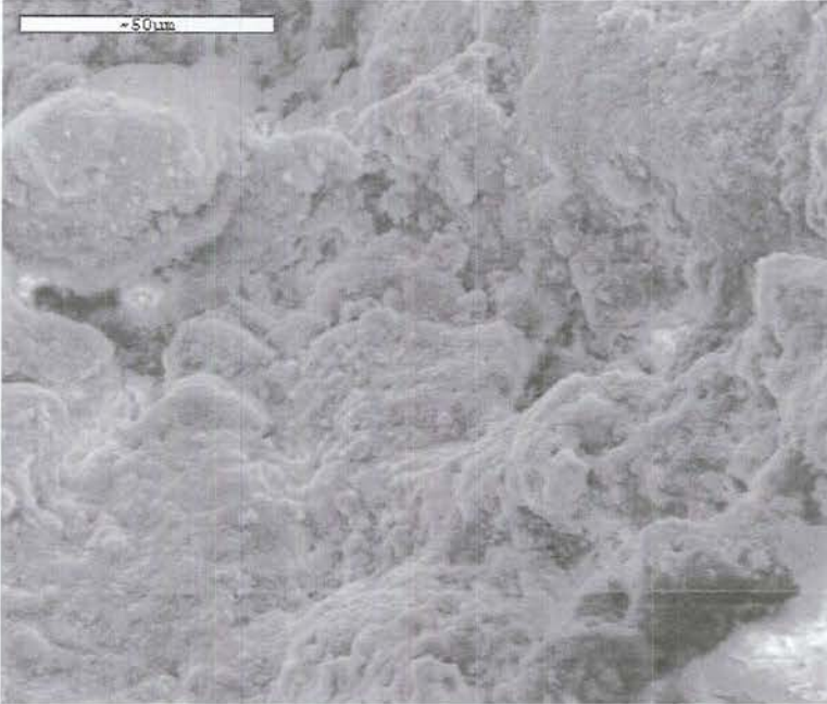
Şekil 5.98. Sızıntı sonrası sepiyolit numunesine ait SEM fotoğrafı
