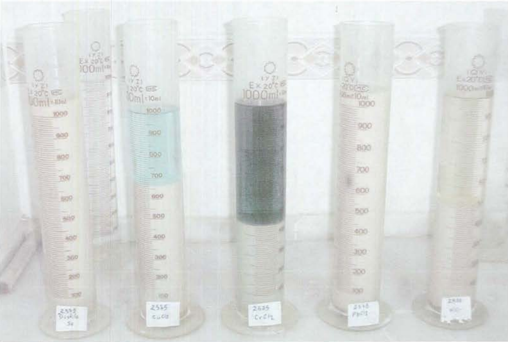
Şekil 5.26. 25K75S karışımının sedimentasyon deneyinden 12 saat sonra çekilmiş bir fotoğrafı (soldan sağa; distile su, Cu, Cr, Pb ve KCl ile hazırlanmış çözeltiler verilmiştir.)
