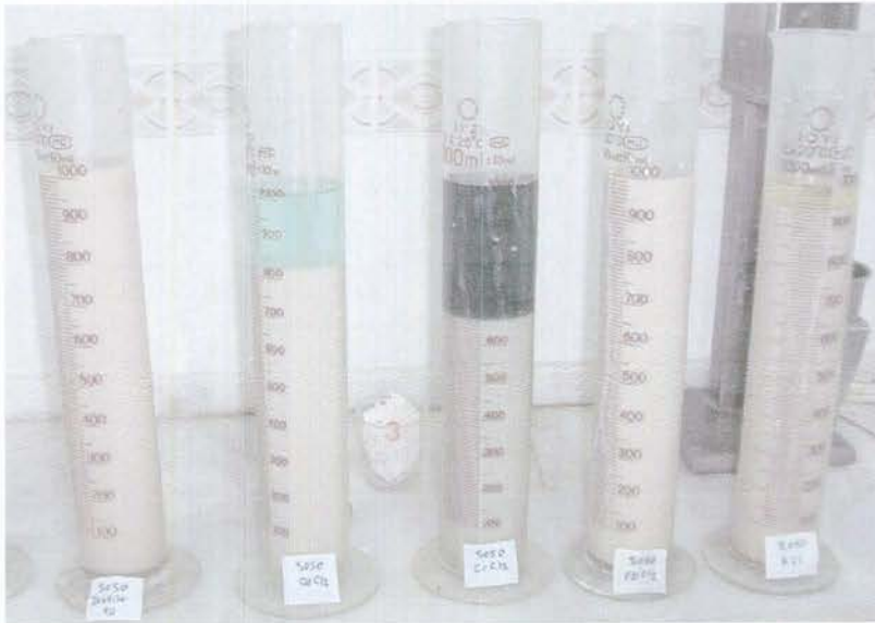
Şekil 5.28. 50K50S karışımının 150 dakikalık sedimentasyon deneyi sonrası çekilmiş bir fotoğrafı (soldan sağa; distile su, Cu, Cr, Pb ve KCl ile hazırlanmış çözeltiler verilmiştir.)
