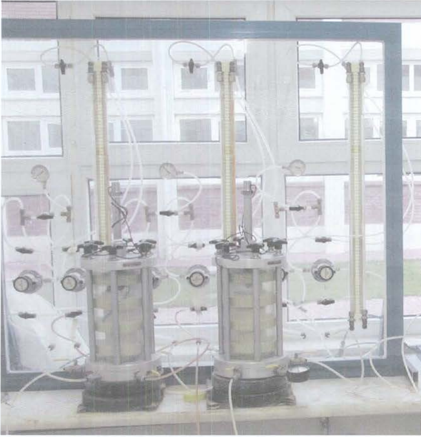
Şekil 4.2. Esnek-duvarlı permeabilite hücreleri ve kontrol panelleri
