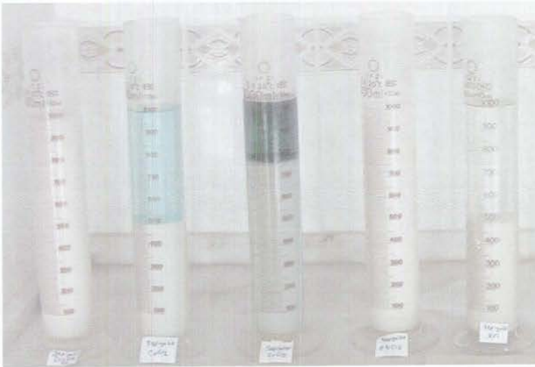
Şekil 5.23. Sepiyolit'in sedimentasyon deneyinden 12 saat sonra çekilmiş bir fotoğrafı (soldan sağa; distile su, Cu, Cr, Pb ve KCl ile hazırlanmış çözeltiler verilmiştir.)
