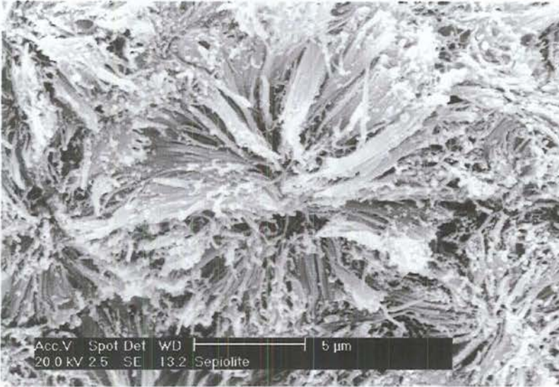
Şekil 3.8. Eskişehir sepiyolitinin lifli yapısının SEM’de görünümü (http-3)
