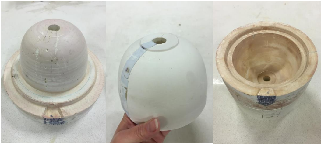
Görsel 6.9. Soldan 1. pozitif kalıp, 2. model, 3. negatif kalıp, (Fotoğraf: Duygu Yıldırım)
