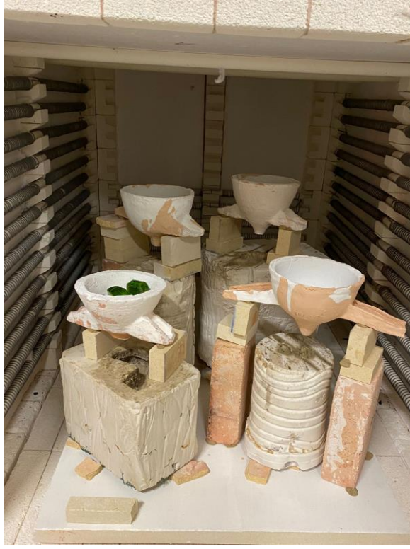
Görsel 3.4. Cam yüklemesi yapılmış pota, (Fotoğraf: Ekrem Kula)
