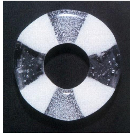
Görsel 6.6. Okuno Mica'nın cam tane boyutunun şeffaflığa olan etkisini gösteren deney halkası, (Kula, 2018)
