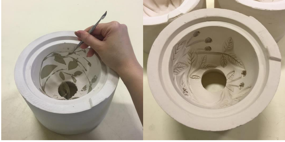
Görsel 6.13. Kalıp yüzeyinin temizlenmesi ve detaylandırılması, (Fotoğraf: Duygu Yıldırım)
