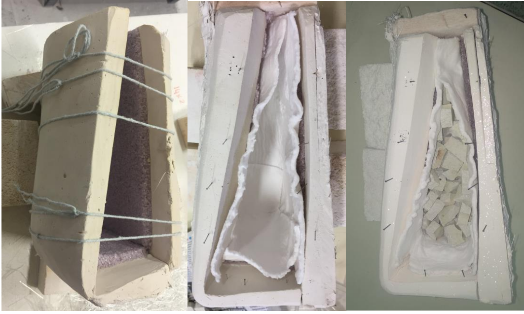
Görsel 6.23. Kalıpların kapatılarak, içlerinin seramik fiber battaniye ve refrakter malzeme ile doldurulması, (Fotoğraf: Duygu Yıldırım)
