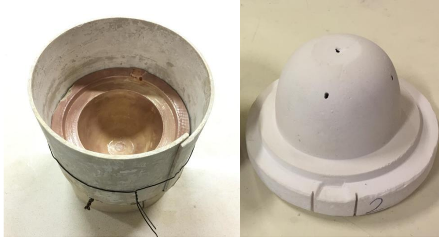
Görsel 6.12. Negatif kalıp alma aşaması, (Fotoğraf: Duygu Yıldırım)
