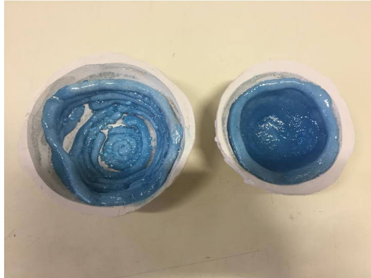
Görsel 6.36. Pate de Verre tekniğinde sucuk yöntemi denemesi, (Fotoğraf: Duygu Yıldırım)
