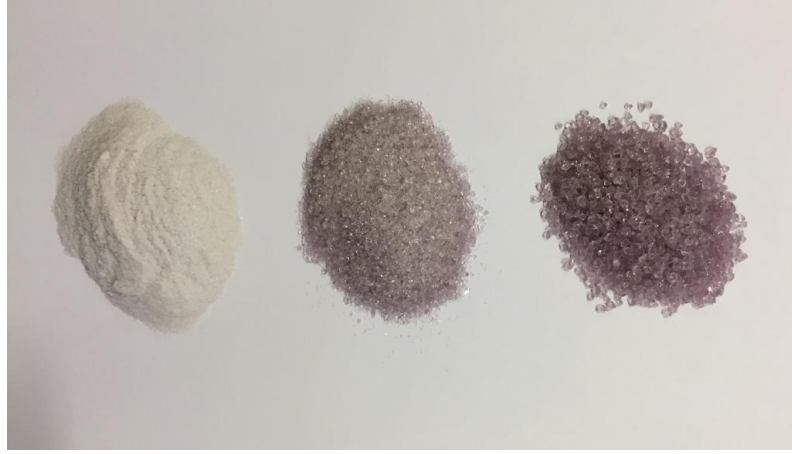
Görsel 6.5. Cam tane boyutlarına ait görsel, soldan sırasıyla; 100 mesh, 10 mesh, 5 mesh, (Fotoğraf: Duygu Yıldırım)
