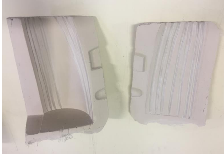
Görsel 6.21. İki parçalı açık kalıp, (Fotoğraf: Duygu Yıldırım)
