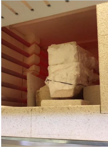
Görsel 6.24. Fırında ısıtma işlemi uygulanması, (Fotoğraf: Duygu Yıldırım)
