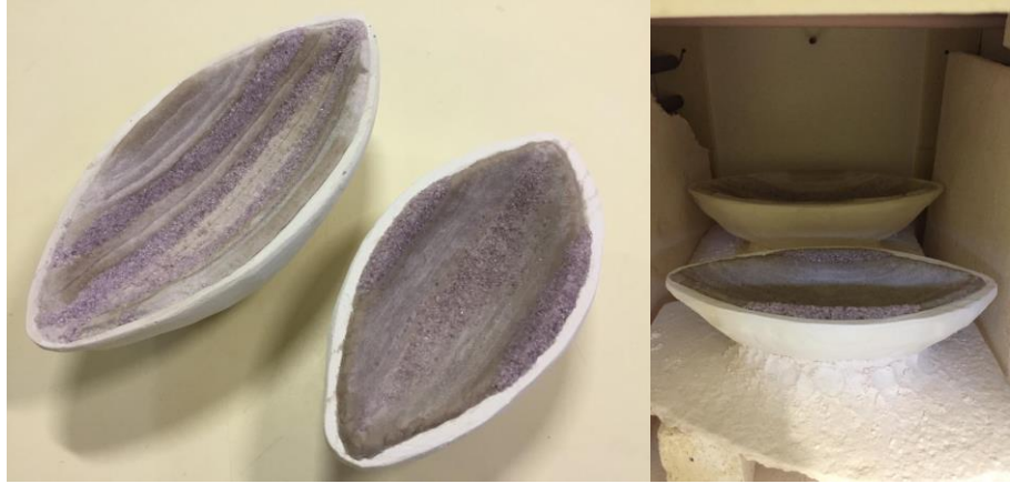
Görsel 6.40. Fırında ısıl işlem uygulaması, (Fotoğraf: Duygu Yıldırım)
