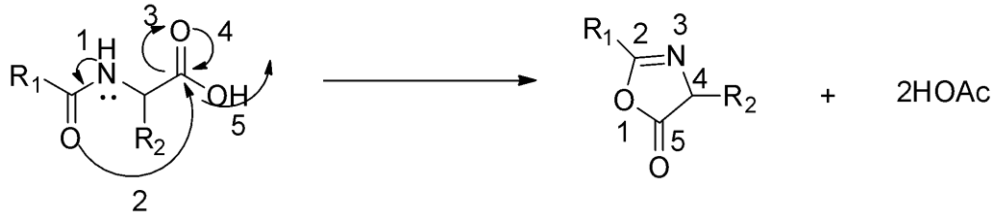
Şekil 2.26. Oksazolonların genel reaksiyon mekanizması
