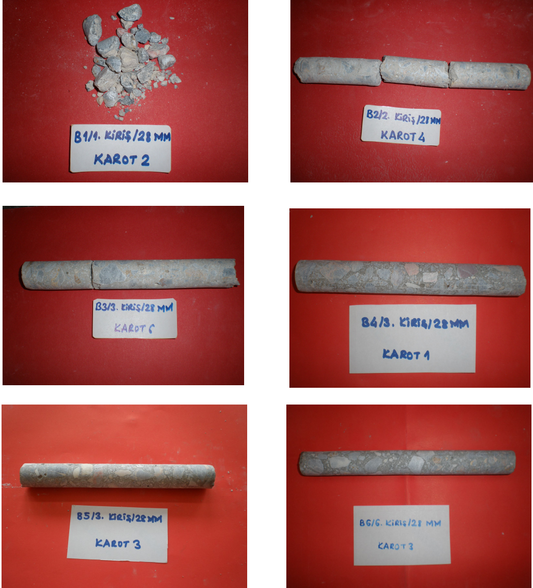
Şekil 6.9. Beton karışımlarından alınan 28 mm çaplı karot numuneler
