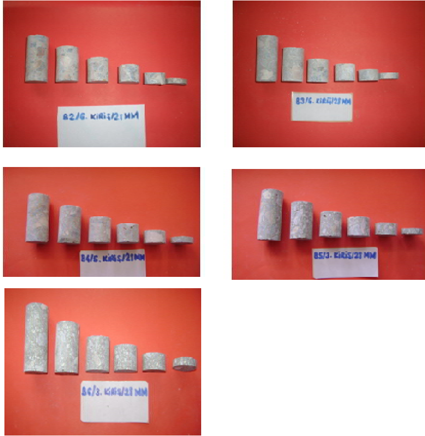
Şekil 6.11. Beton K1 karışımı hariç diğer karışımların tümünden alınan 28 mm çapındaki mikrokarotların farklı boy/çap oranlarında kesilmiş hali
