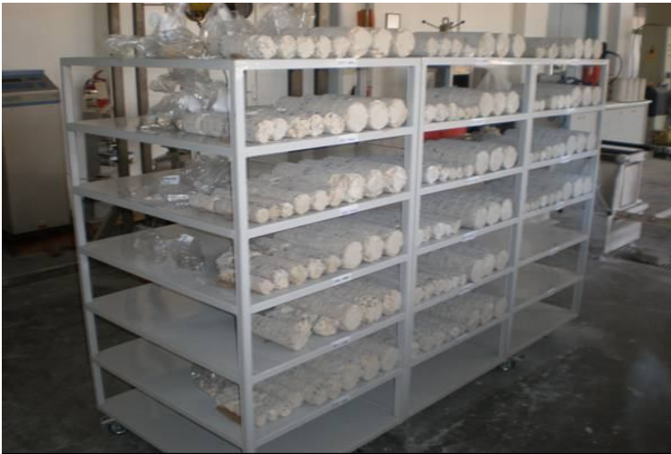
Şekil 6.5. Kiriş elemanlardan alınan farklı çaplardaki karot numunelerin depolanması
