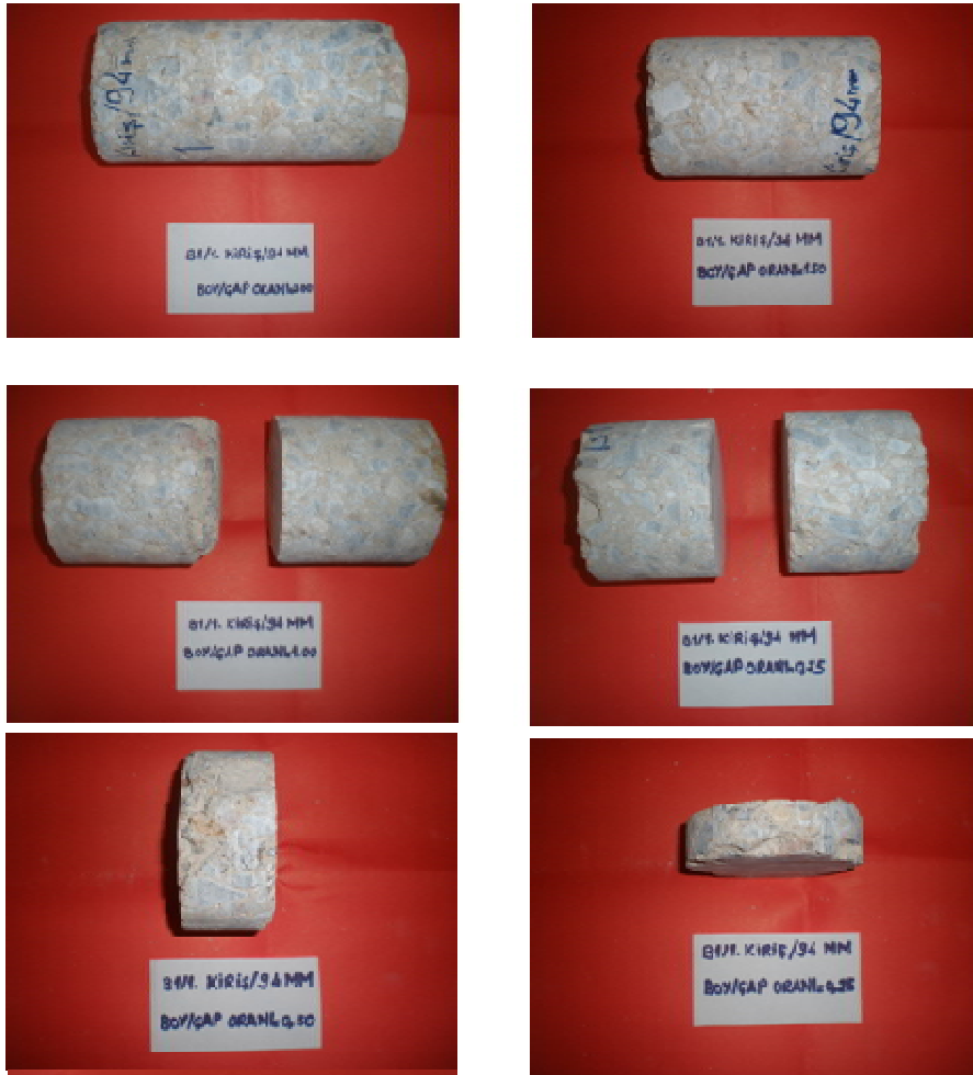
Şekil 6.10. Beton K1 karışımlarından alınan 94 mm çaplı ve farklı boy/çap oranına sahip karot numuneler
