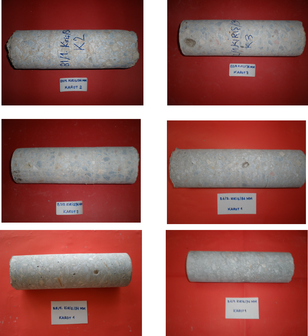
Şekil 6.6. Beton karışımlarından alınan 94 mm çaplı karot numuneler
