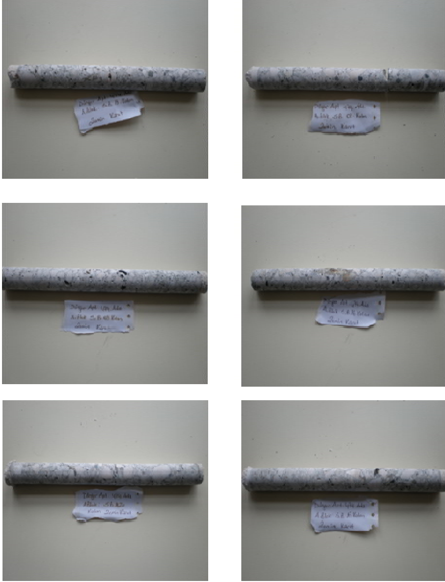
Şekil 6.12. Bina 1'de farklı taşıyıcı elemanlardan alınan 28 mm çapındaki mikrokarot numuneler
