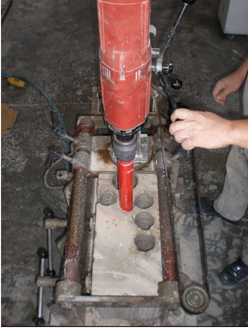
Şekil 6.4. K1 beton karışımında kiriş elemandan 46 mm çapında karot alınması
