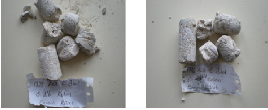
Şekil 6.13. Bina 6’da farklı taşıyıcı elemanlardan alınan 28 mm çapındaki mikrokarot numuneler
