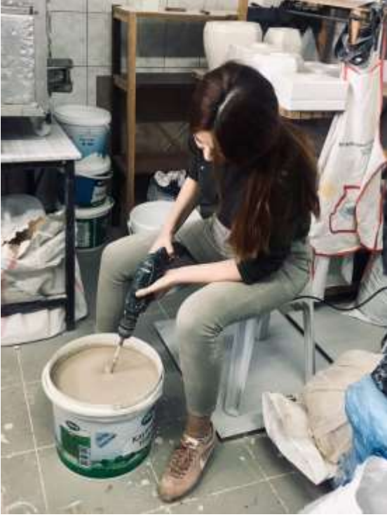
Görsel 4.10. Porselen çamurunun hazırlanması
