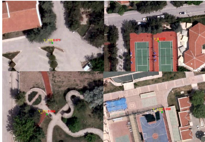
Şekil 7. 3. Düşük hataya sahip nokta konumları ve hata miktarları (Kaynak: Yazar tarafından üretilmiştir.)
