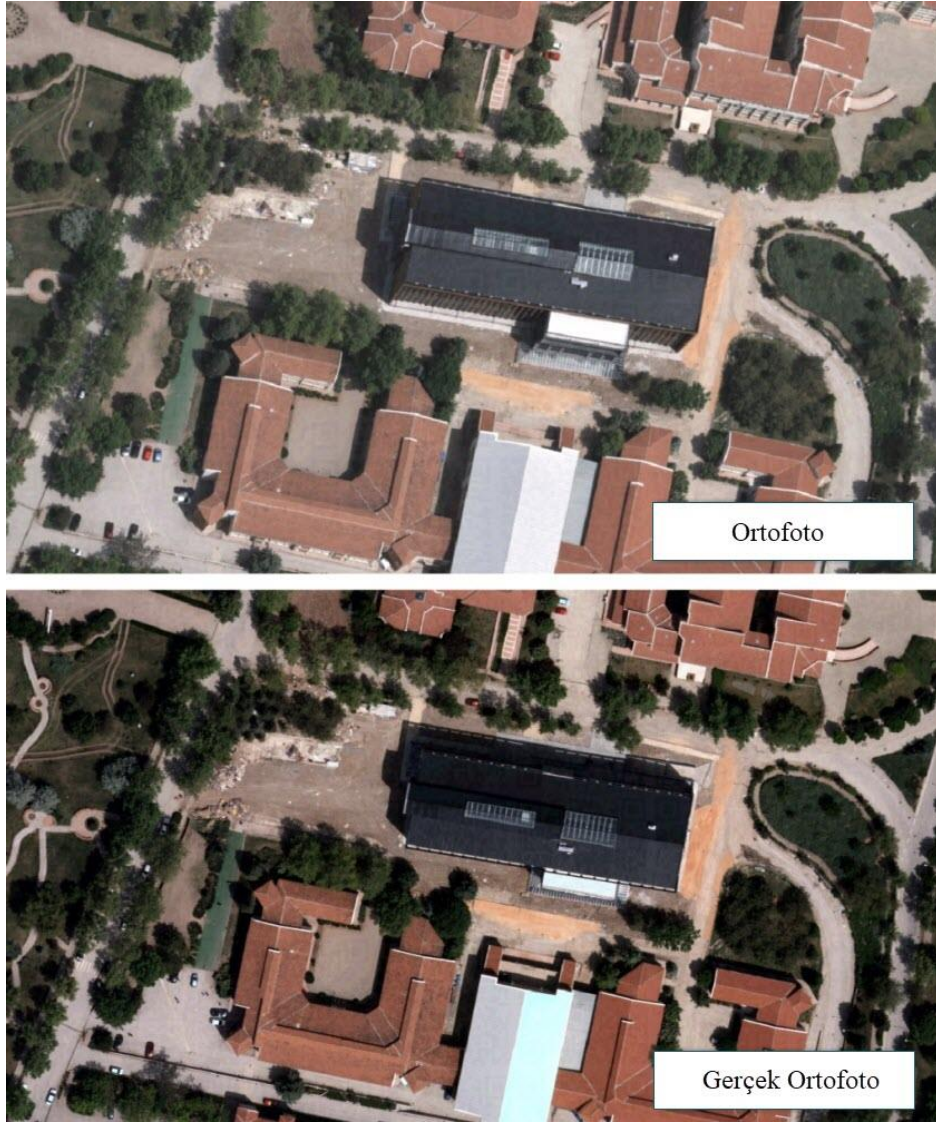
Şekil 4. 7. Klasik ortofoto ile gerçek ortofoto harita arasındaki fark (Kaynak: Yazar tarafından üretilmiştir.)
