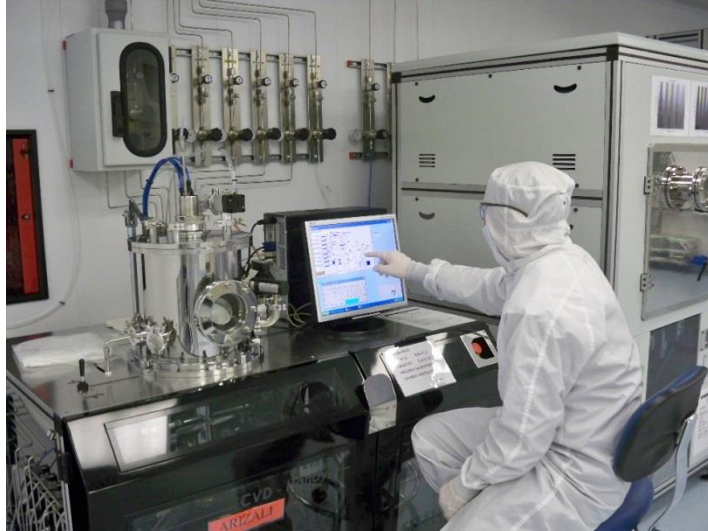
Şekil 2.7. UNAM temiz alan içerisinde bulunan PECVD cihazı
