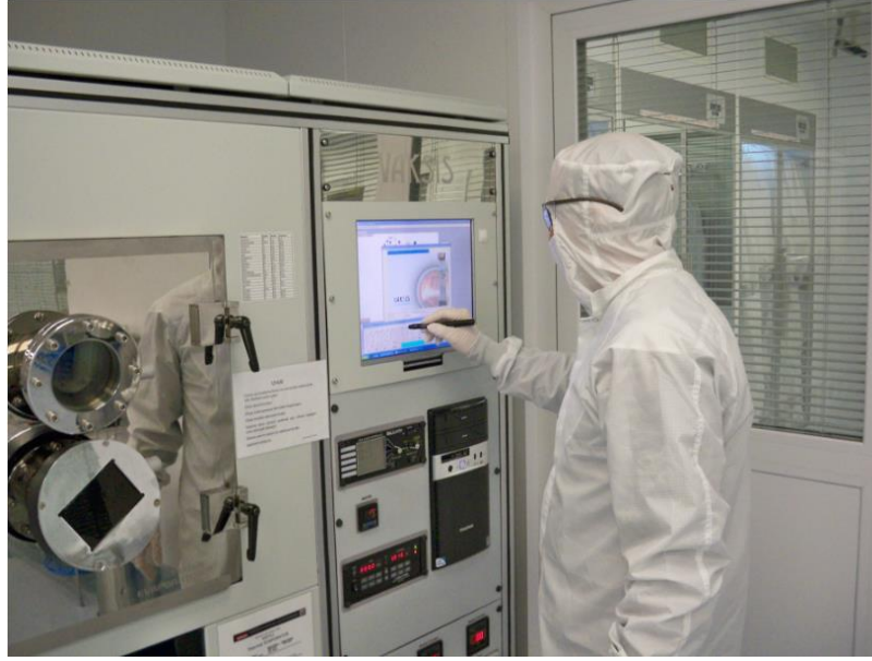
Şekil 2.5. UNAM temiz alan içerisinde bulunan termal biriktirme cihazı
