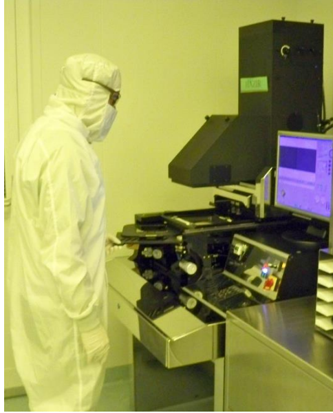
Şekil 2.25. UNAM alt yapısında bulunan EVG-620 UV maske litografi cihazı
