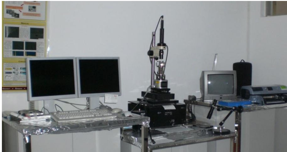
Şekil 2.14. Anadolu Üniversitesi Malzeme Bilimi ve Mühendisliği, İnce Film Laboratuvarında bulunan Atomik Kuvvet Mikroskobu
