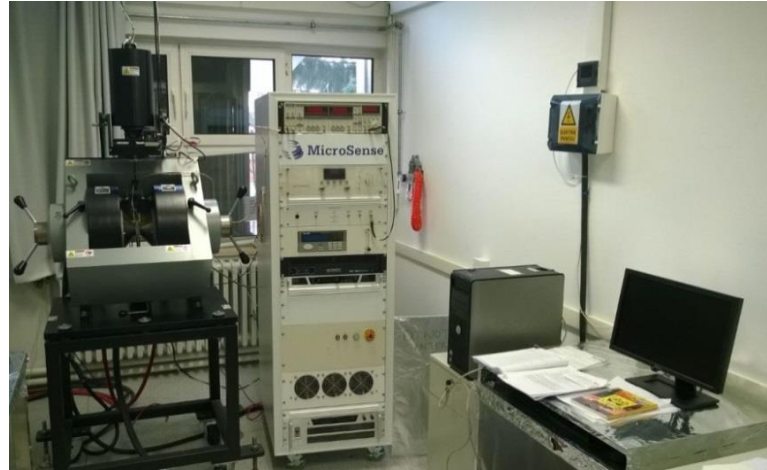
Şekil 2.16. Manyetik karakterizasyonlarında kullanılan MicroSense marka VSM cihazı
