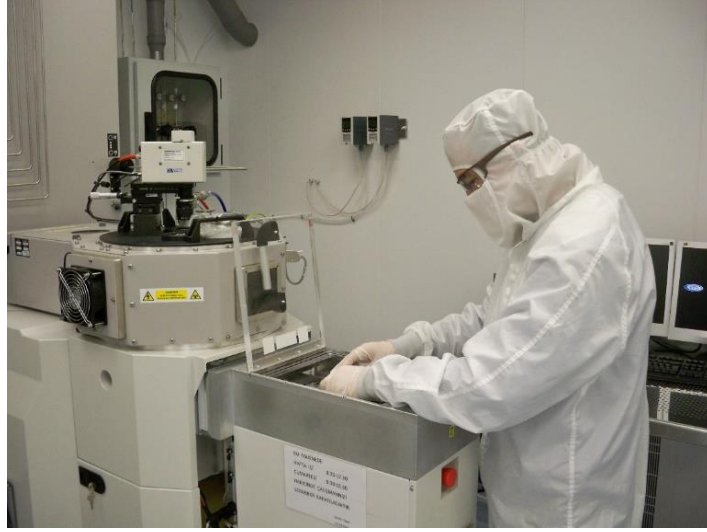
Şekil 2.26. UNAM alt yapısında bulunan Fiziksel aşındırma sistemi
