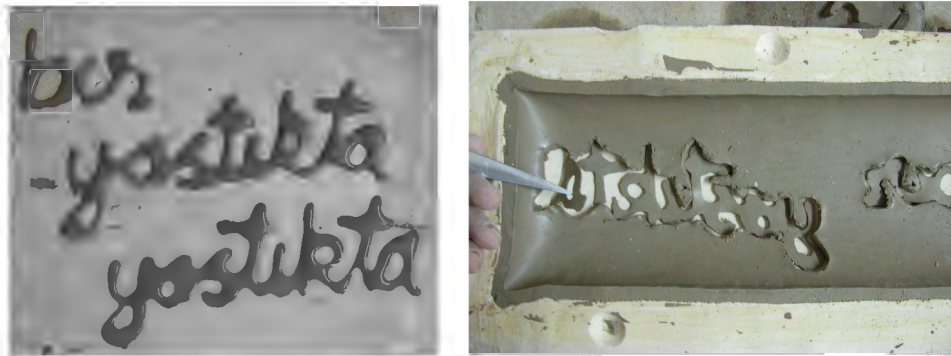
Sergi Uygulama Resim 26-27. Alçı Kalıp Üzerinde Purla Oluşturulmuş Yazılar ve Bunların Ters Çevrilip Alçı Kalıp İçindeki Parçanın Yüzeyine Taşınması
