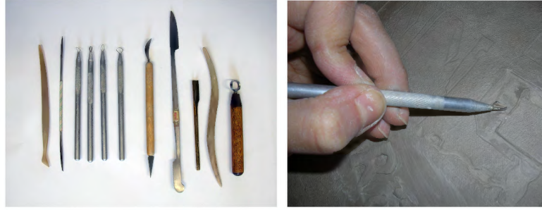
Resim 137. Kazıma Aletleri Resim 138. Kazıma Uygulaması Fotoğraf: Ezgi Okur
