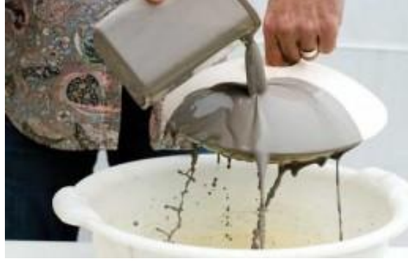
Görsel 2.30. Astar akıtma uygulaması
