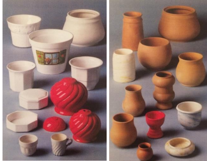
Görsel 2.19. Döner ve sabit kafalı preslerle yapılan çeşitli formlar Endüstriyel Seramikte Alçı ve Çamur Şekillendirme Yöntemleri (Müşteba Kundul)
