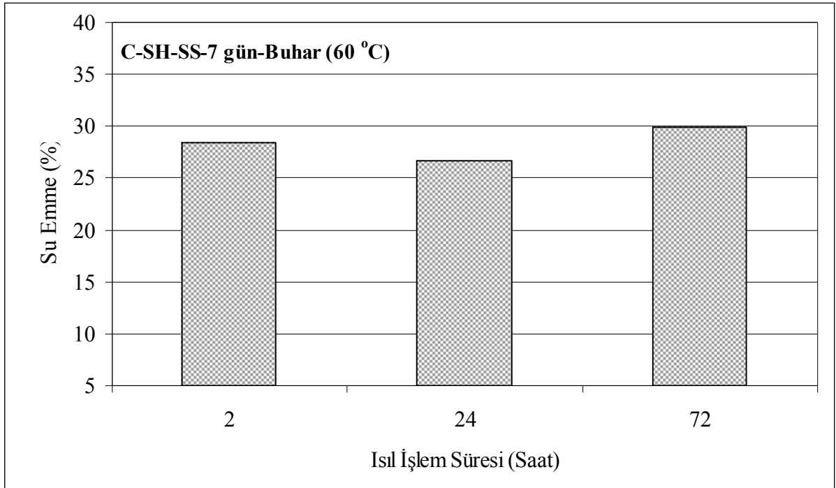
Şekil 3. 24 Buhar odasında ısıtılarak üretilen uçucu kül (C)-sodyum hidroksit (SH)-sodyum silikat (SS) esaslı geopolimer tuğlaların 7 günlük su emme miktarları
