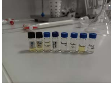
Görsel 3.4. HPLC cihazı için hazırlanan standart maddeler
