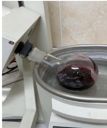
Görsel 3.2. Rotavaporda çözücülerini uçurma işlemi
