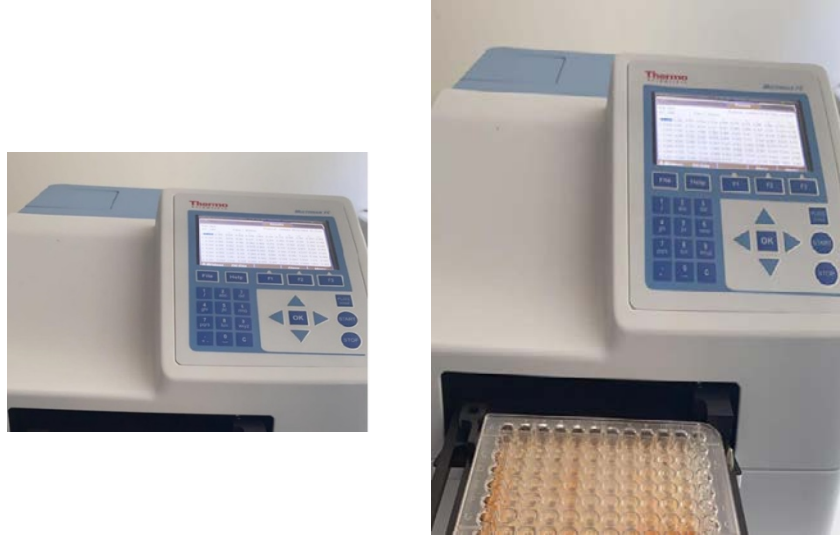
Görsel 3.9. MTT reaksiyonu hazırlanan platelerin absorbans değerlerinin okunduğu Elisa plate okuyucu
